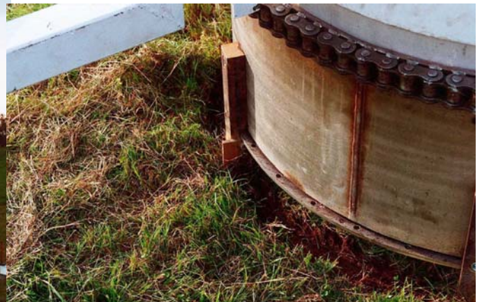
Abb. A 3.1 c Bohrkronen der Fräsvorrichtung
