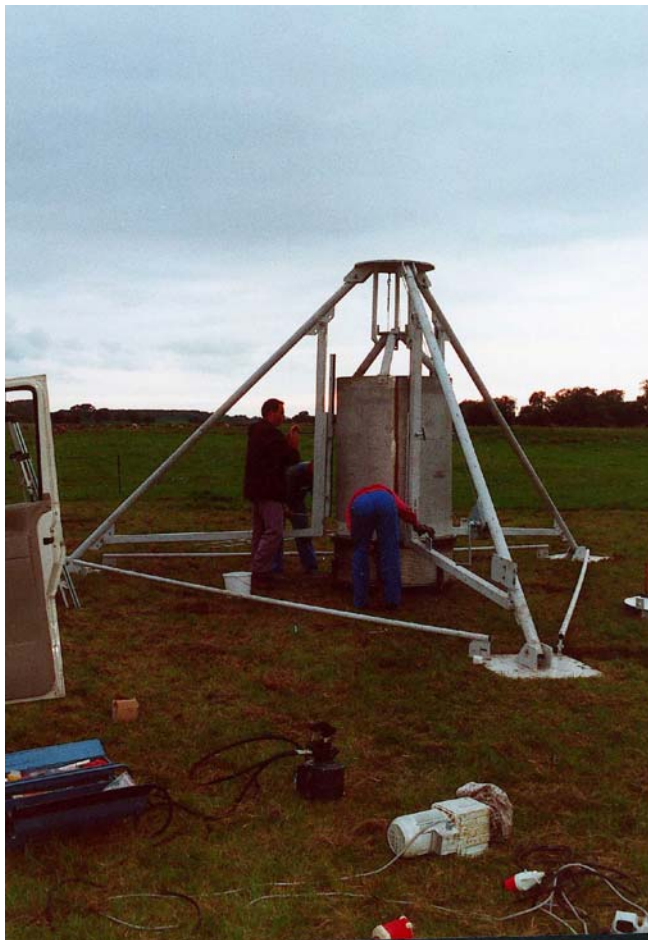
Abb. A 3.1 a Vorrichtung zur monolithischen Entnahme von Bodensäulen
