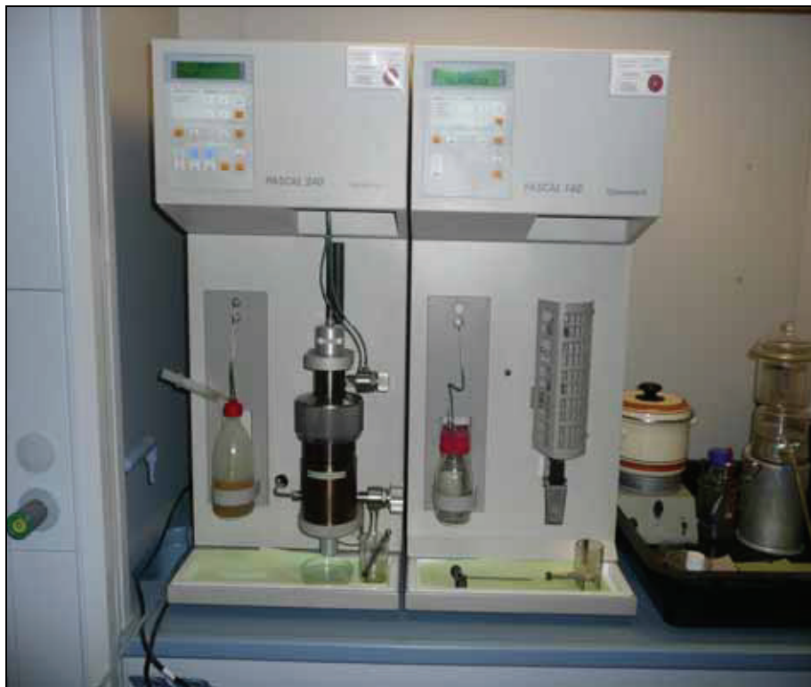
Abbildung A4-1: Messgerät für die Porosität von Baustoffen (Quecksilberporosimetrie). Labor Wismar.
