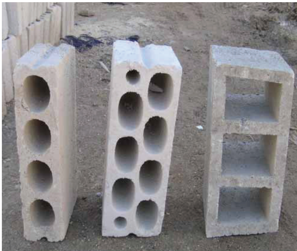
Abbildung A2-4: Beispiele von in Syrien verwendeten Hohlblocksteinen. Hohlblockstein für Wände mit 10 cm (links) und 15 cm Dicke (mittel) sowie für Stahlsteinplatten mit 18 cm Dicke (rechts).
