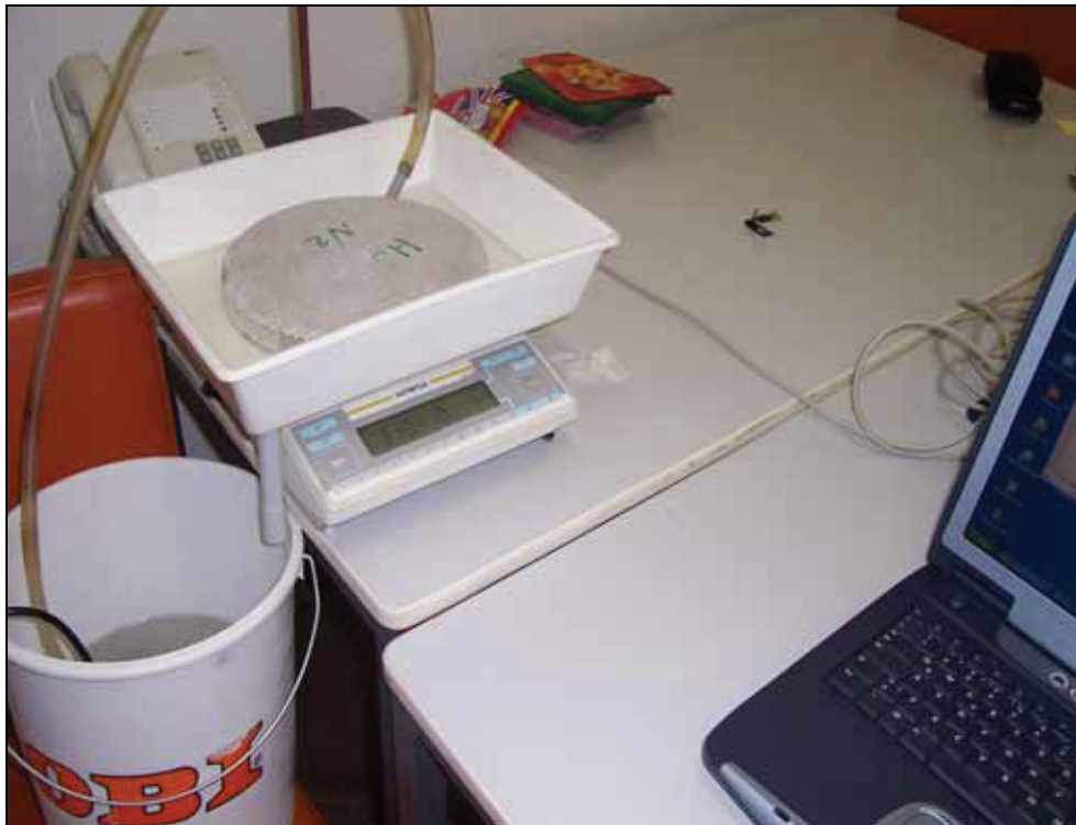
Abbildung A4-7: Automatische Messung des Wasseraufnahmekoeffizienten W_w der untersuchten Baustoffe. Links: Waage mit Überlaufschale und Probe, rechts: Auswertungscomputer.
