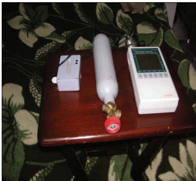
Abbildung A5-4: Versuchsmaterialien zur Bestimmung des natürlichen Luftwechsels mit Hilfe von Tracergas nach DIN EN ISO 12569. CO 2 -Konzentrationsfühler (links), Flasche reinen CO 2 -Gases (mittel), und Messgerät (rechts).
