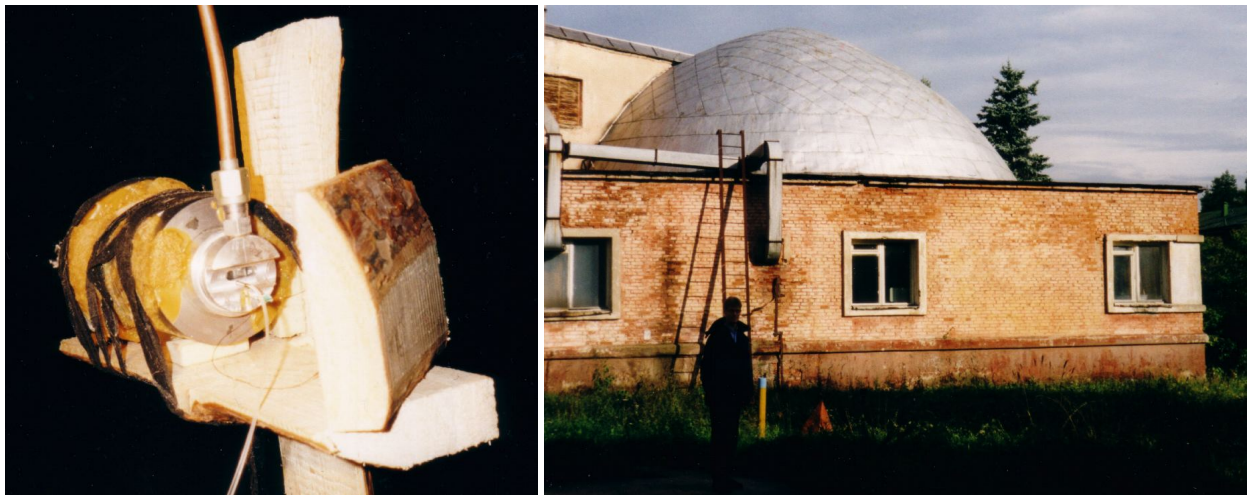
Abbildung 2.3: Stoßexperiment mit Sprengstoff in Chernogolovka. Linkes Bild zeigt den experimentellen Aufbau. Rechtes zeigt die Sprengkammer.
