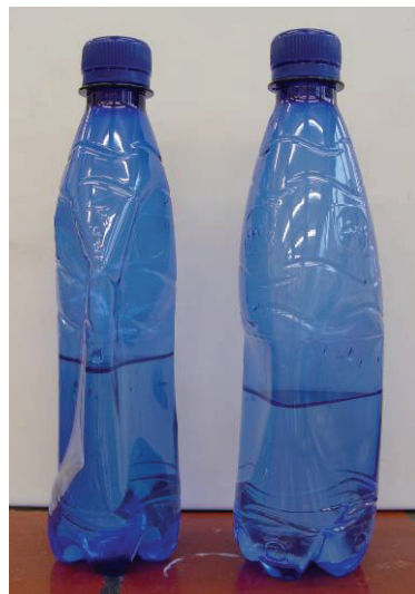
Abb. 27: Kohlenstoffdioxid löst sich in Wasser, wodurch die Flaschen einbeulen
