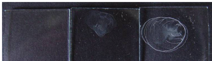
Abb. 33: Eingedampfte Wassertropfen (links: destilliertes Wasser, mittig: Leitungswasser, rechts: Mineralwasser)
