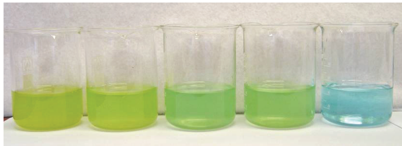
Abb. 40: unterschiedliche Filtrate bei Benutzung der verschiedenen Filter v.l.n.r.: Ausgangslösung/-suspension, Kaffeefilter Mild, Kaffeefilter Classic, Kaffeefilter Kräftig, Rundfilter
