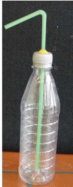
Abb. 3: Ersatzvariante für eine Spritzflasche
