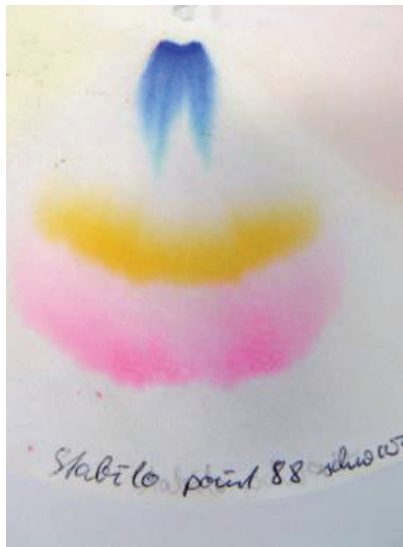
Abb. 42: Chromatogramm eines Stabilo®-Fineliner „point 88“
