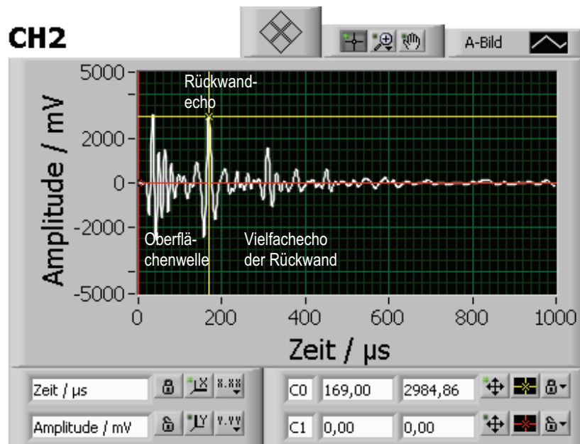
Abbildung 38: Laufzeit/Intensitäts-Bild (A-Bild), Laufzeitkurve an einem Punkt einer ungeschädigten Kieferprobe (10 cm dick) mit deutlichem Rückwandecho und Vielfachecho der Rückwand [Geräteausdruck BAM]
