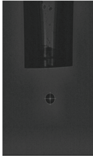
Abbildung 48 – Kamerabild mit Projektion des erkannten Tropfens
