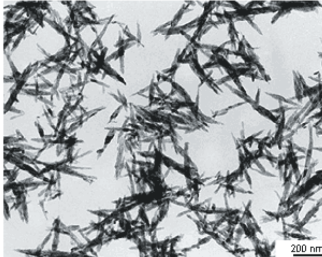
Abb.18: Präzipitierte HA- Kristalle (aus Herstellerinformation Ostim®- Heraeus-Kulzer, 2003)
