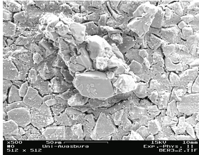
Abbildung 24: REM-Aufnahme des porösen Rohres. Mittig im Bild ist ein Splitter des Materials zu sehen, der beim Präparieren des Rohres entstand. Er zeigt den dreidimensionalen Aufbau des porösen Materials
