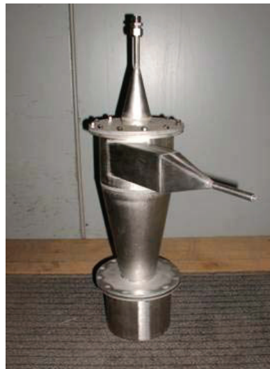
Abbildung 27: Zyklon des Probenahmesystems
