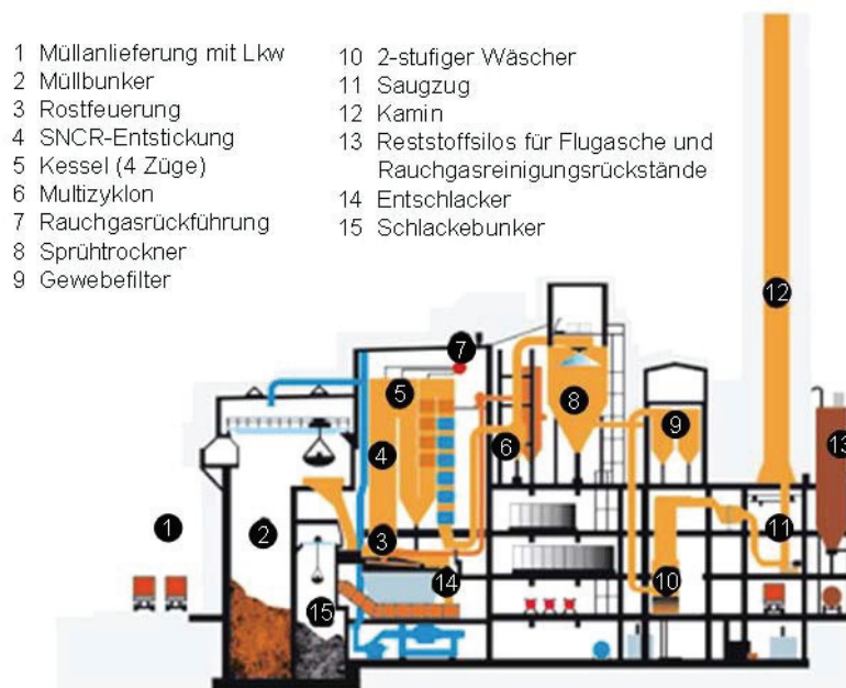
Abbildung 2: Prinzipieller Aufbau einer Verbrennungsanlage für Siedlungsabfall (Quelle: Umweltbundesamt/GKS)
