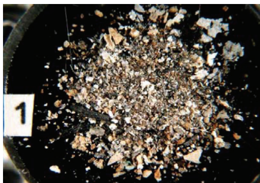
Abbildung 60: Zykloninhalt aus dem 1. Zug (Höhe der Ziffer ist 5 mm)
