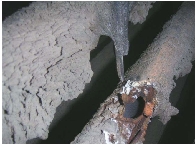
Abbildung 7: Rohrreißer eines Überhitzerrohres im Bereich des ersten Überhitzers des 3. Zuges. Zu sehen auch der dicke Belagbart beim benachbarten Rohr (Foto: GKS)
