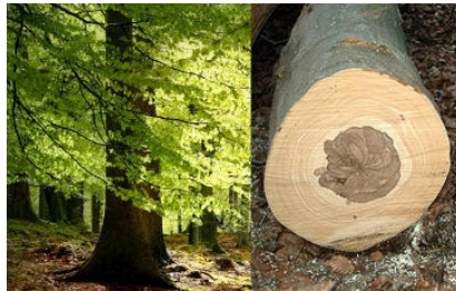
Abb. 4- 5: Buchenmischwald in Dänemark und Querschnitt eines Rot-Buchenstammes mit ausgeprägtem Rotkern [96, 97]
