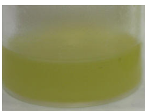
Abb. 5- 21: leicht grün fluoreszierendes ethanolisches Leinwurzelextrakt
