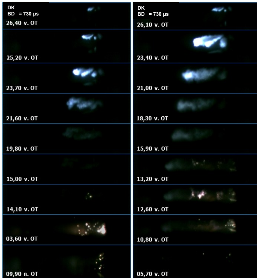
Abb. 7-10 Einspritzvorgang und Zündung einer Kraftstoffmenge in der Größenordnung der für die Motorversuche vorgesehenen VE-Mengen bei einem EB von 27°KW v. OT [EPP13]
