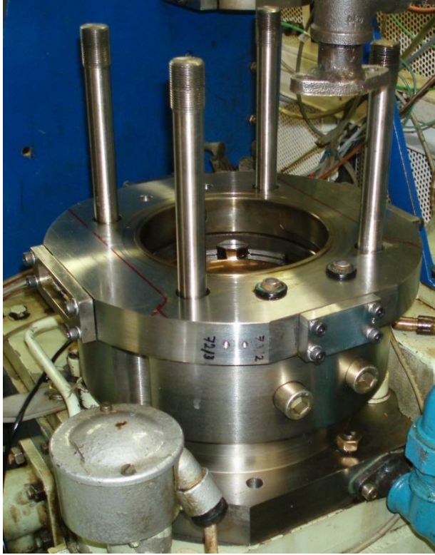
Abb. A 1 Optischer Zugang zum Brennraum am Einzylinder-Forschungsmotor 1VDS 18/15
