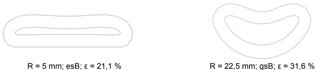
Abbildung 88: Beispiele für physiologisch auszuschließende Querschnittsdeformationen durch lokales geometrisches Versagen der Prüfschlauchwand (esB - ebene starre Bettung, gsB - gekrümmte starre Bettung)
