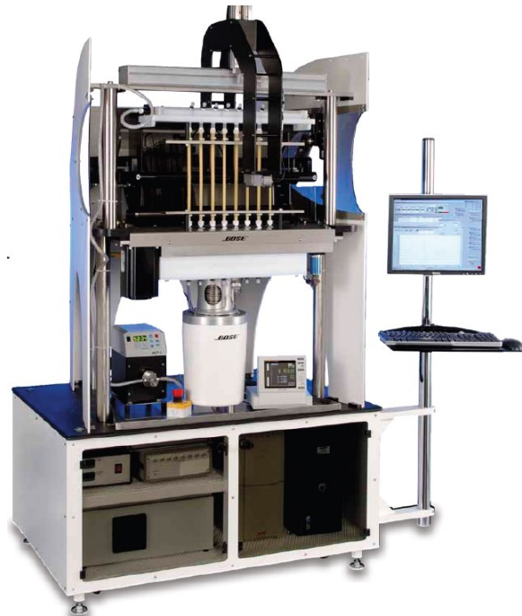
Abbildung 30: Multiaxialer Prüfstand ElectroForce®9400 (Bose Corp., Minnesota, USA) für periphere Stents [23]
