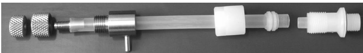
Abbildung 37: Silikonprüfschlauch mit Fixiervorrichtungen. Die linke Fixiervorrichtung wird im Führungselement, die rechte (Einschraubverschraubung) am Schlitten befestigt
