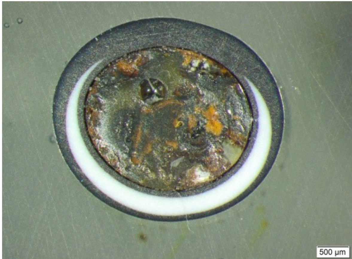
Abbildung 42: Vollständige Inkrustation des Stent_8 beim Stentabschnitt 22
