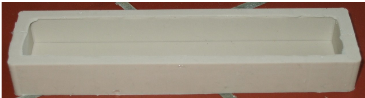
Abbildung 11: Silikoneinbettform (140 x 30 mm)
