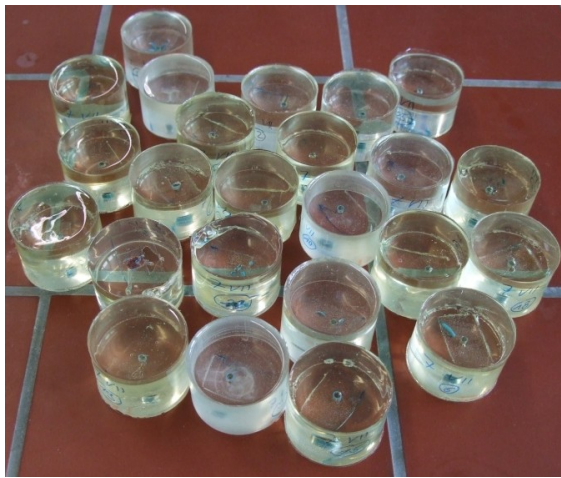
Abbildung 20: Ausgehärtete Harzblöcke mit den ausgeschnittenen Stentsegmenten
