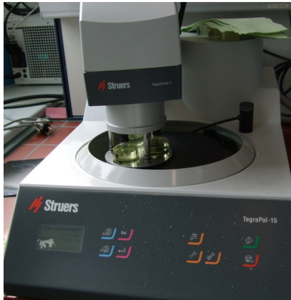
Abbildung 22: Polier- und Schleifmaschine TegraPol-15, Struers ApS mit entsprechendem Aufsatz (TegraForce-1, Struers ApS) und 3 Proben-Zylindern
