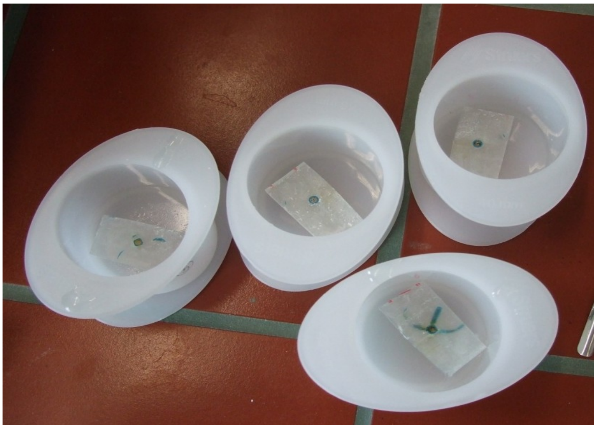
Abbildung 19: Die einzelnen Schnitte werden in je eine zylindrische Einbettform, zum erneuten Einbetten in vertikaler Richtung, eingebracht
