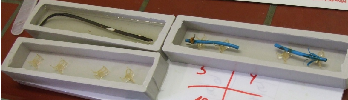
Abbildung 12: Silikonform mit darin liegenden Uni-Clips als Platzhalter(unten links) und mit aufgelegten Stents (oben rechts). Aufgrund einer axialen Deformität konnte der Stent oben links nicht auf Uni-Clips gelegt werden
