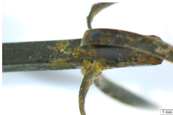
Abbildung 8: Proximales Ende Stent_14. Sichtbar sind Auflagerungen und Verfärbungen des Stents
