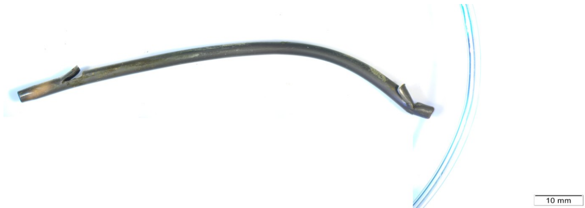
Abbildung 6: Die Übersichtsaufnahme von Stent_8 (AS) zeigt die deutliche Verfärbung des ursprünglich weißen Stents
