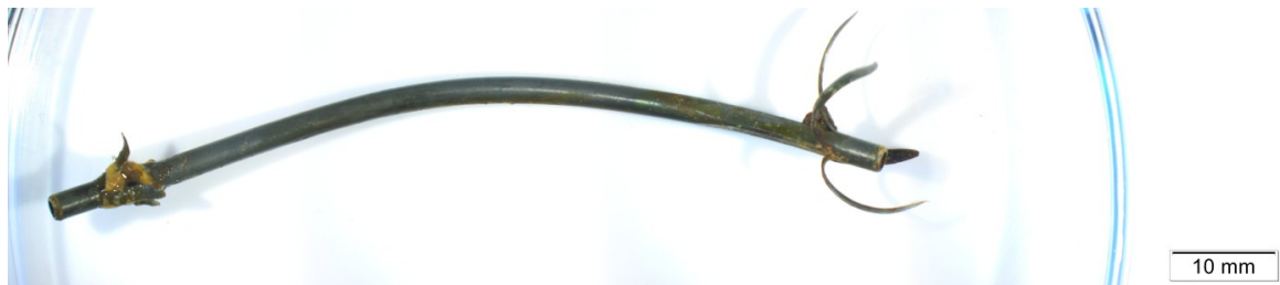
Abbildung 7: Die Übersichtsaufnahme von Stent_14 (TS) zeigt die deutliche Verfärbung des ursprünglich blauen Stents. Ablagerungen sowohl am Ansatz der proximalen, als auch der distalen Flaps
