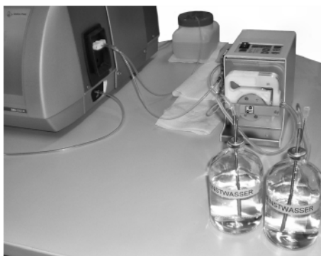
Abb. 3.8. Biegeschwingerdensimeter mit T-Ventilsystem. Das Standardmeerwasser (im Foto Reinstwasser) wird direkt aus den gelieferten 250 mL-Gefäßen gepumpt. Die Peristaltikpumpe ist dem T-Ventil vorgeschaltet. Die Schläuche, die auf die Nadeln, Ventile usw. aufgesteckt sind, waren undicht, als die Pumpe allen Komponenten nachgeschaltet war. Das T-Ventil erhöht den Strömungswiderstand. Das Schlauchmaterial ist nicht dauerhaft resistent gegen Standardmeerwasser.
