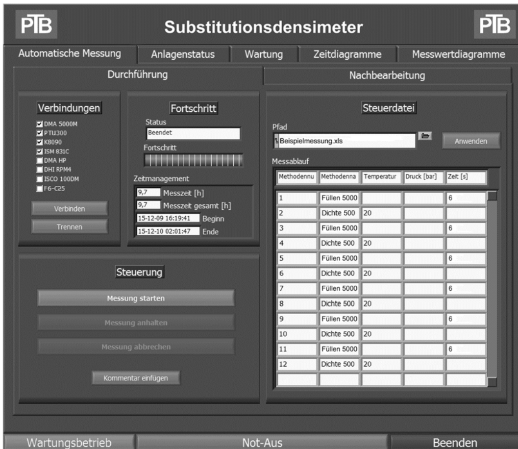
Abb. 3.12. Steuerprogramm nach einer automatischen Messung bei Atmosphärendruck. Der Ablauf einer automatischen Messung wurde in der Steuerdatei „Beispielmessung.xls“ festgelegt, vom Programm eingelesen und abgearbeitet. Der zeitliche Fortschritt wurde dargestellt.
