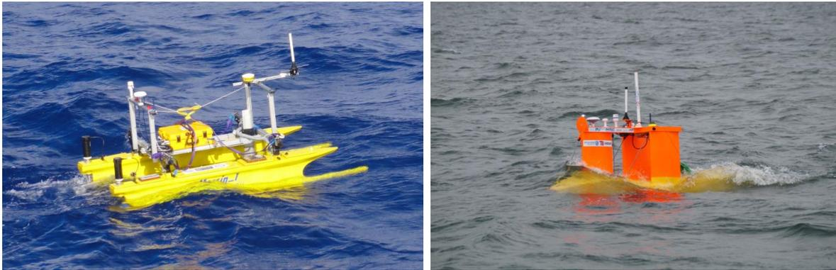
**Abbildung 6.1.:** Darstellung der für die Validierung der Entwicklungen eingesetzten USV des Lehrstuhls Regelungstechnik der Universität Rostock, links: MESSIN, rechts: SMIS-USV
