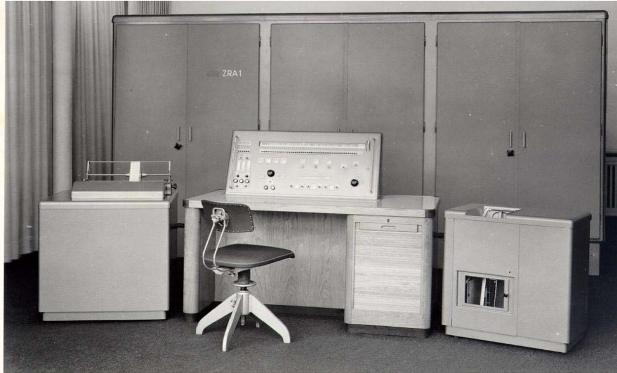
Abbildung 3: Ein aufgebauter ZRA 1
