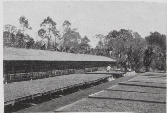
Abb. 45 Kakao-Trockenanlage. Bei plötzlichem Regen können die Auslagen schnell unter die Schutzdächer gerollt werden. Finka San Isidoro bei La Vega. (Domin. Republik)
