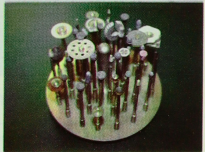
Abb. 2: Werkzeugausstattung für die Fertigung künstlicher Herzen
