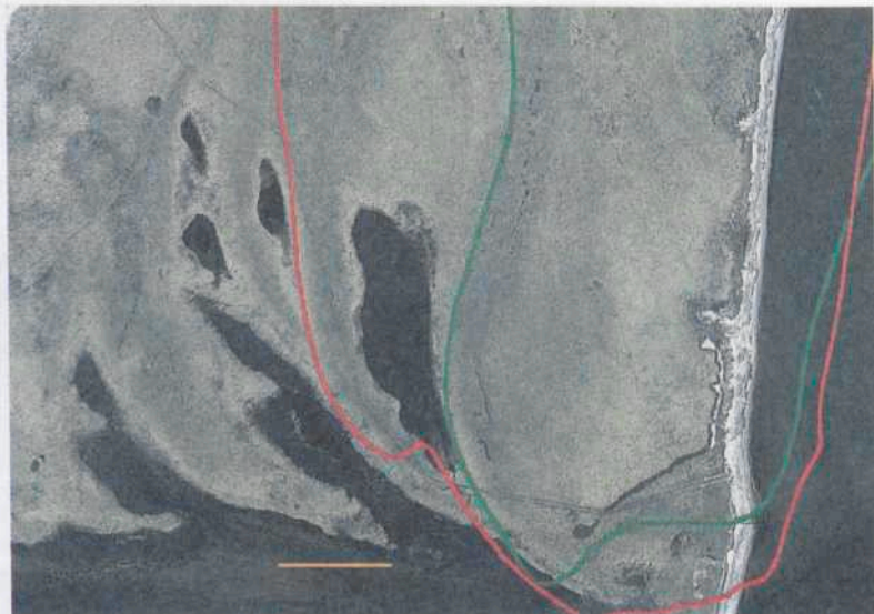
Abb. 2: Die Umringe der Insel Langenwerder, selektiert aus der schwedischen Matrikelkarte (grün) und der Flurkarte (rot), auf das Luftbild gelegt. Die Umringe passen gut mit den Dämmen der Insel (schmutzig-grüne Strukturen) überein und deuten so eine relativ hohe Genauigkeit der Einpassung der Karten an. Der Maßstabsbalken entspricht 50 m.
