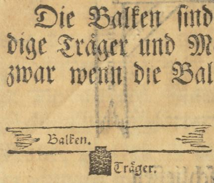
Die Balken sind auf die inn- und auswendige Träger und Mauer-Platten gehörig, und zwar wenn die Balken lang und schwer zu tragen haben, mit doppelten oder Mittel-Kämmen zu verkämmen: Welches insbesondere bey Brücken-Balken observiret werden muß.
