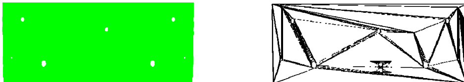
Bild 41: Tankdecke eines Doppelbodens (links: Flächen, rechts: Polygone)
