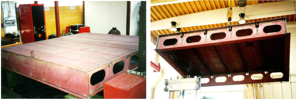
Abbildung 3.7: Charakteristischer Ausschnitt einer realen Decksstruktur im Zustand "Stahl" im Labor, Abmessungen: 3.0 m×3.5 m×0.4 m
