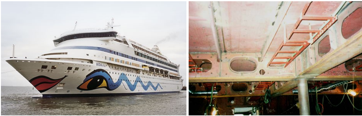
Abbildung 3.5: Kreuzfahrtschiff „AIDAvida“ sowie ein typischer Ausschnitt einer Decksstruktur an Bord des Schiffes
