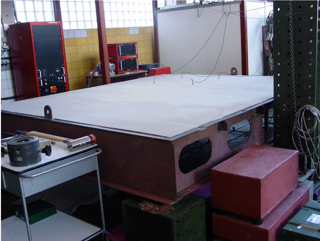
Abbildung A7.9: Laborstruktur mit Decksbelag entsprechend Messort 1 der Werftmessung
