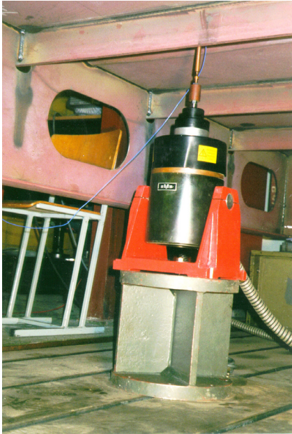
Abbildung A7.13: Ankopplung des elektrodynamischen Erregers an die Laborstruktur
