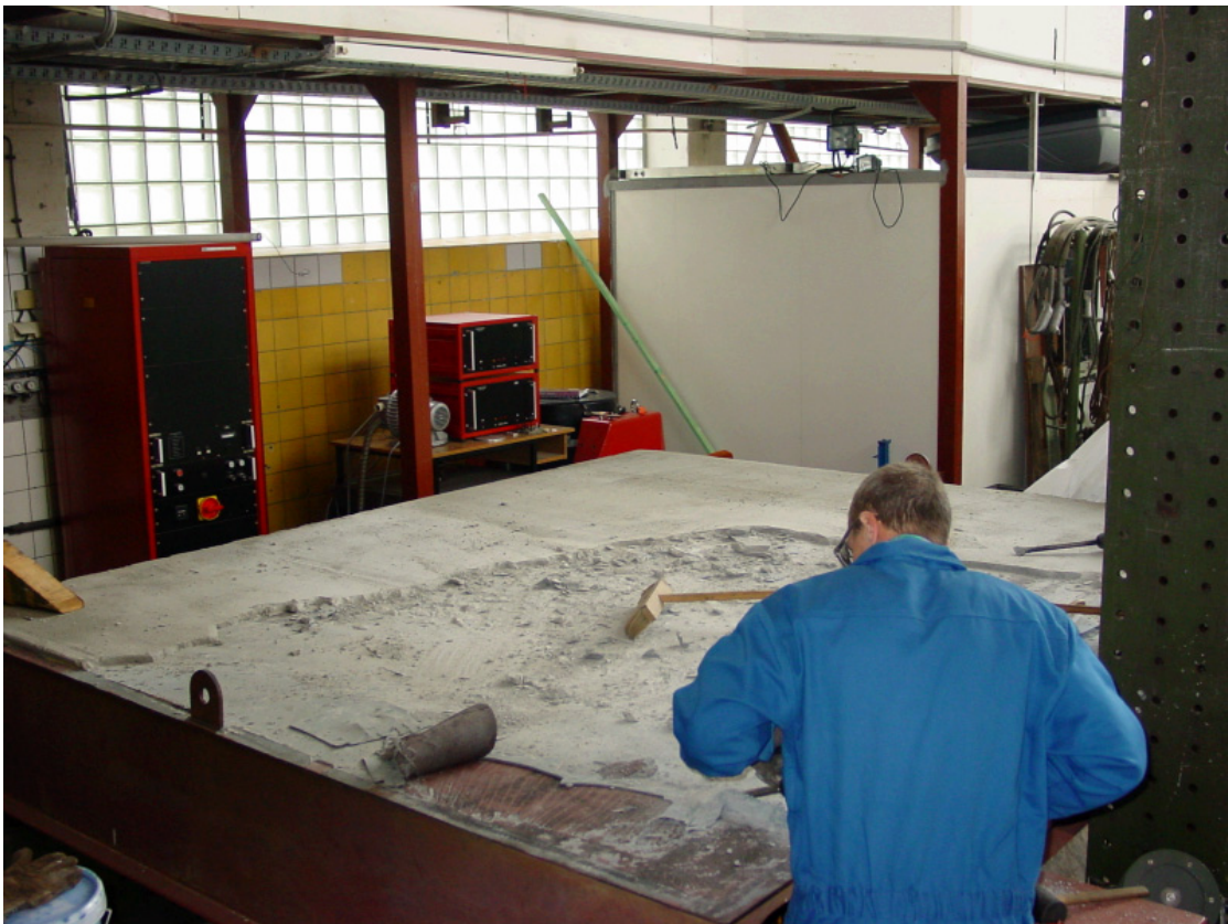
Abbildung A7.12: Laborstruktur beim Entfernen des Decksbelages entsprechend Messort 4 der Werftmessung
