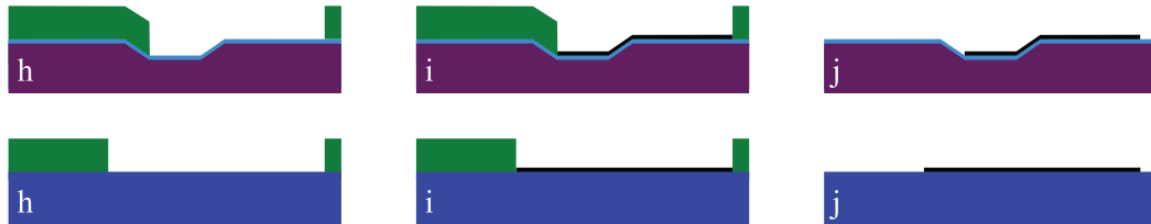
Abbildung 4.22: Technologische Schritte zum Erzeugen der Elektroden durch Katodenzerstäuben (Sputtern) auf dem Silizium- und Pyrexwafer
