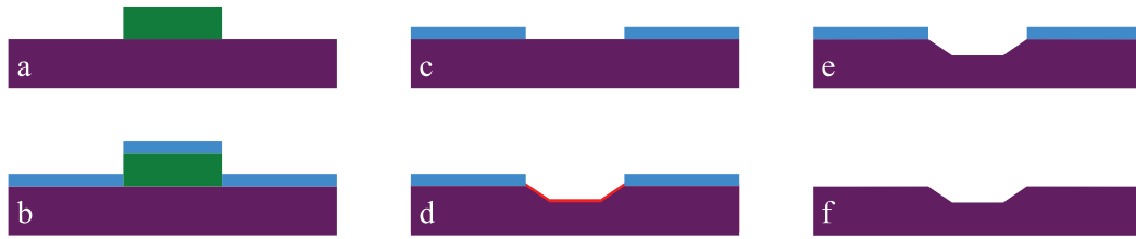
Abbildung 4.20: Technologische Schritte zum Erzeugen der Grabenstruktur durch nasschemisches Ätzen
