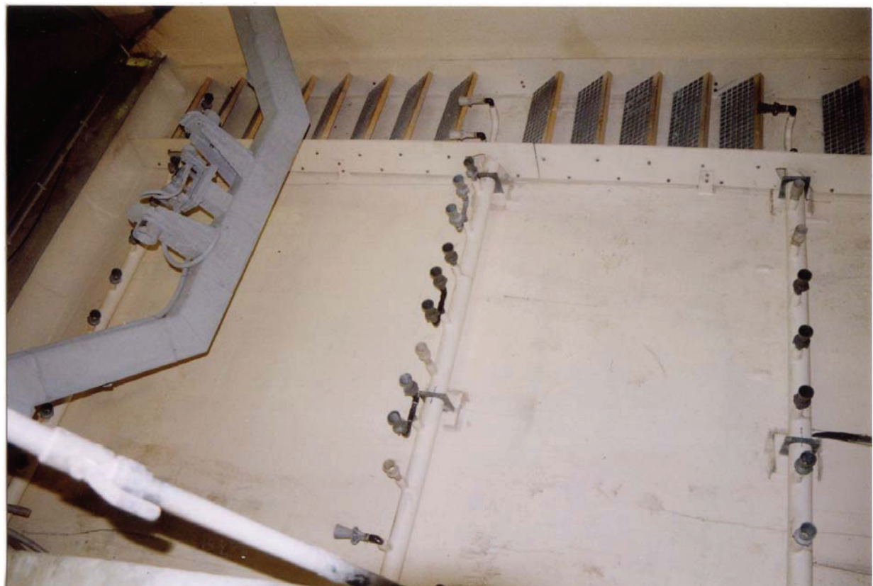
Abb. 11.1-2 Ausrichtung der Körtlingdüsen im Bugbereich
