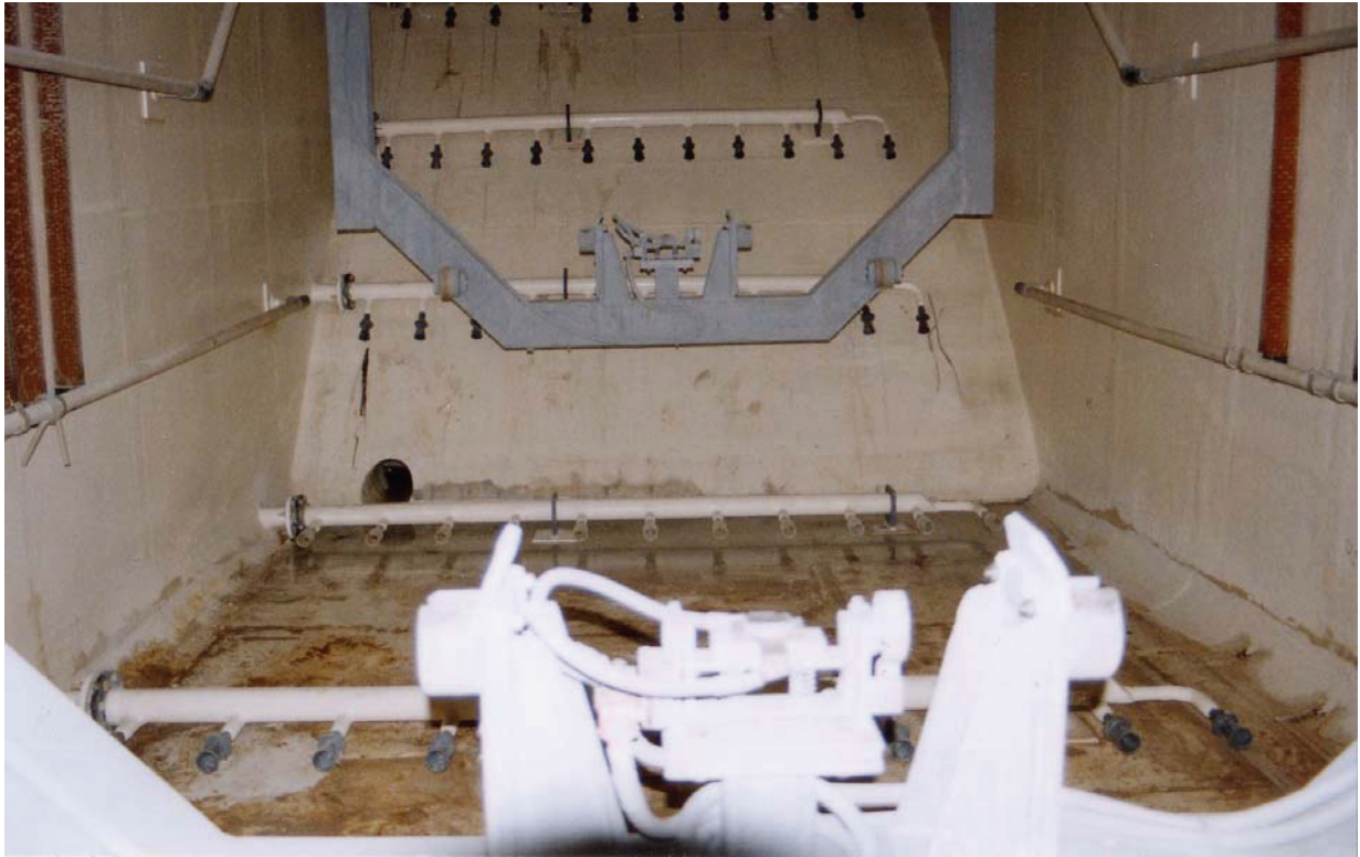
Abb. 11.1-5 Ansicht des Bodenflutsystems im KTL-Becken
