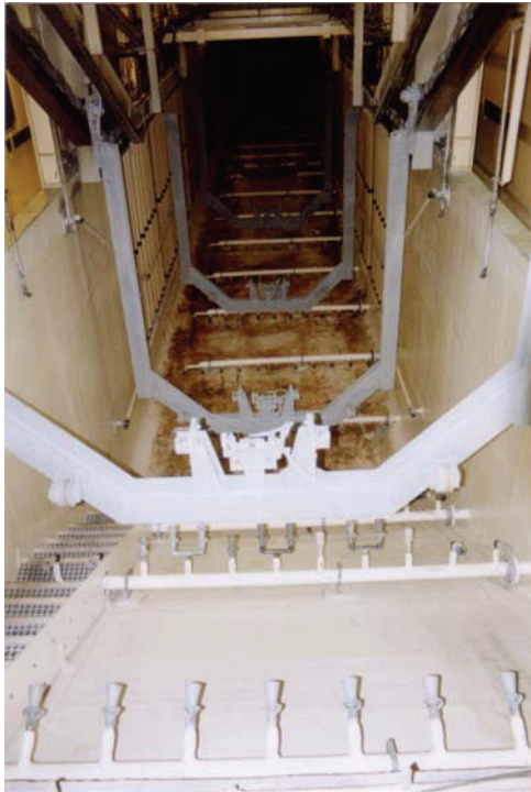
Abb. 11.1-1 Übersicht KTL-Becken Pendelförderer und Bodenflutsystem mit Körtlingdüsen
