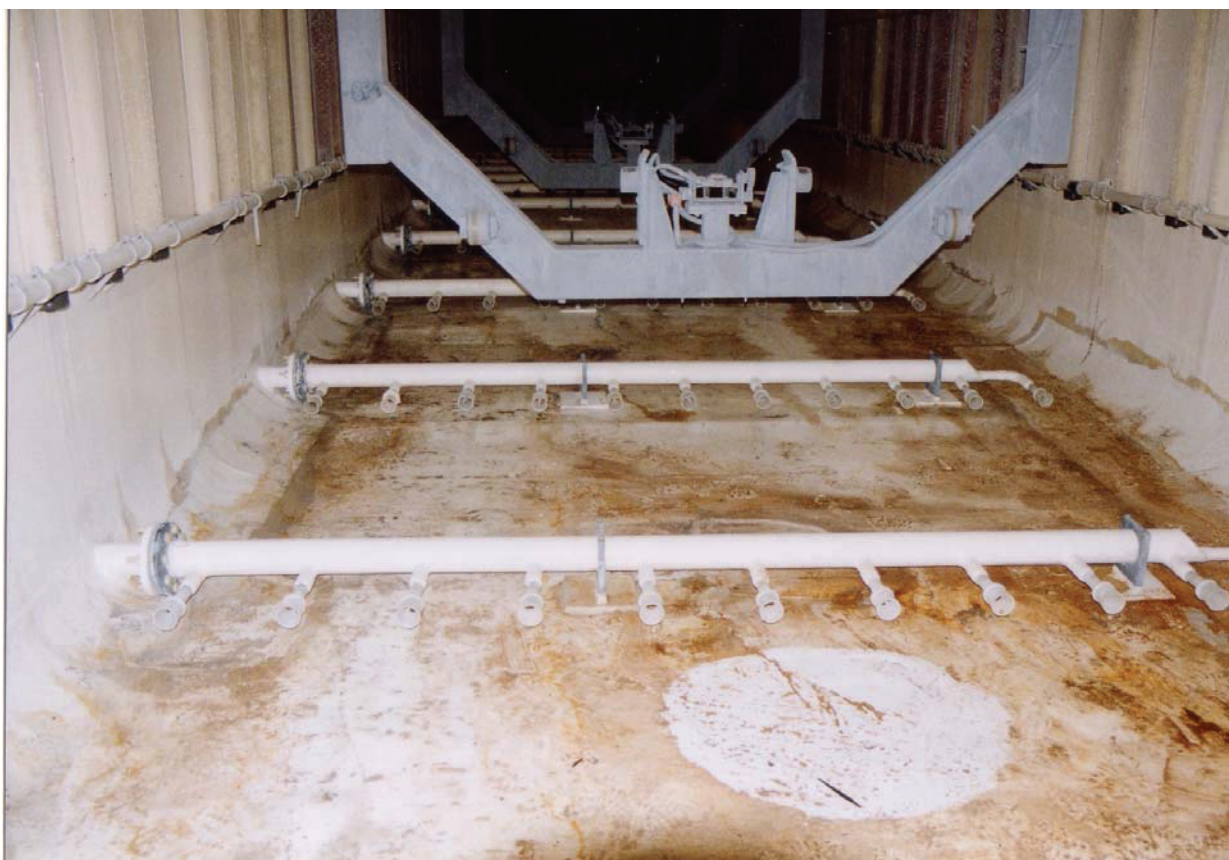
Abb. 11.1-4 Ansicht des Bodenflutsystems im KTL-Becken
