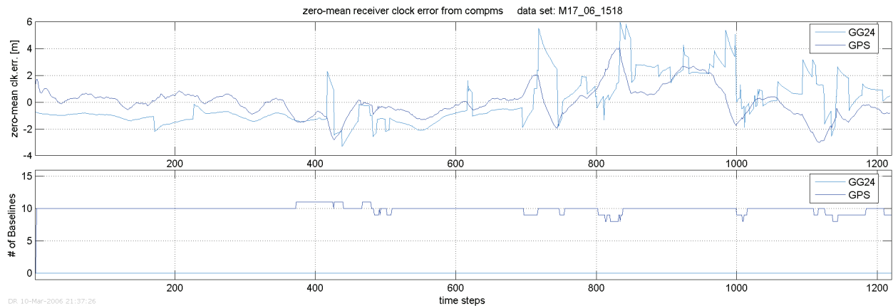
Abb. 2.6-16 Empfängeruhrenfehler der GPS- und der GG24 Lösung
