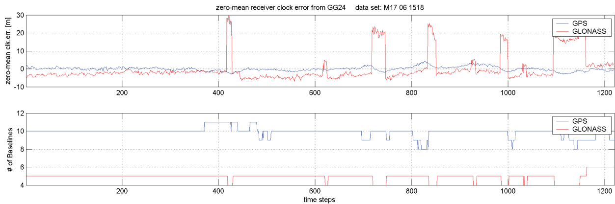
Abb. 2.3-1 Berechneter Empfängeruhrenfehler für GPS und GLONASS
