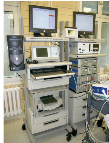
Abbildung 19: Hardwaresystem zur Druckmessung und digitalen Datenerfassung
