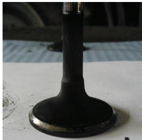
Abbildung 83: Einlassventil des Motors Tre 18 nach [88]
