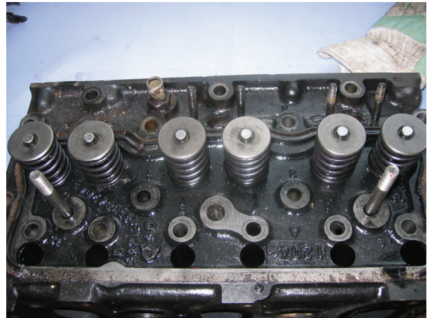
Abbildung 78: Oberseite Zylinderkopf des Motors Tre 87 nach [88]
