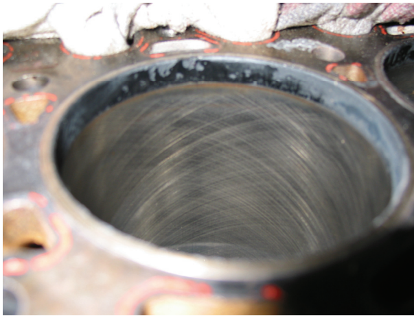
Abbildung 70: Zylinderlaufbuchse des Motors Tre1 nach [88]
