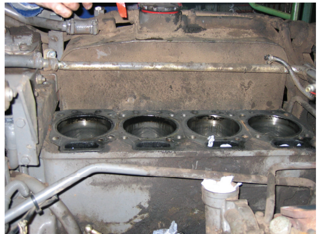
Abbildung 63: Zylinderlaufbuchsen des Motors Tre 17 nach [88]
