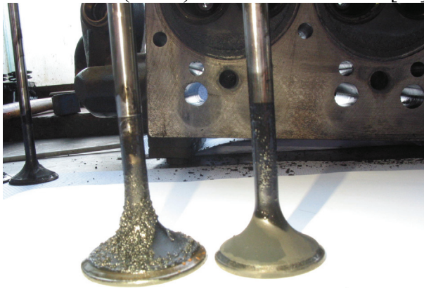
Abbildung 87: Auslasskanal (links) Einlasskanal (rechts) des Motors TRE87 n.[88]
