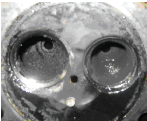
Abbildung 82: Einlasskanal (links); Auslasskanal (rechts) des Motors Tre18 n.[88]
