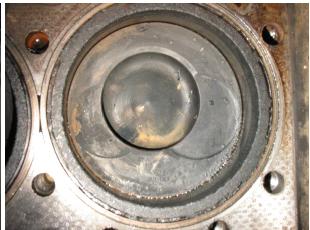
Abbildung 76: Kolbenboden des Motors Tre 87 nach [88]
