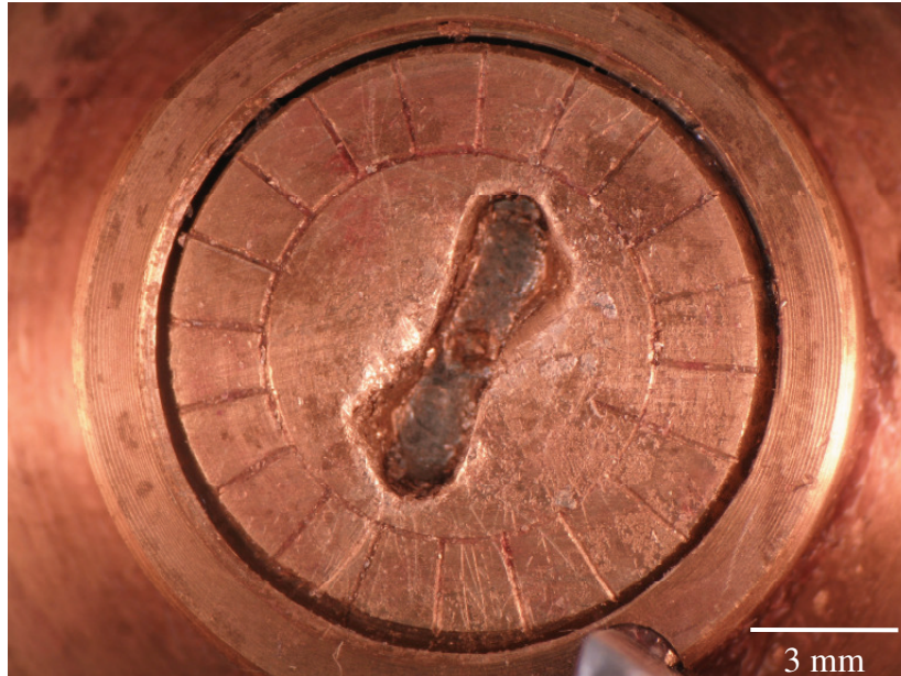
Abb. 11: Nachstellschraube mit Kerbe und eingefrästen Teilstrichen (projektionsmikroskopische Aufnahme)
