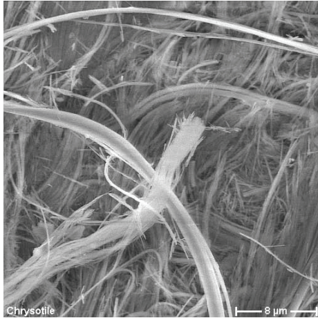
Abb. 14: Rasterelektronenmikroskopische Aufnahme des Chrysotils. Vergrößerung: 3000x.
