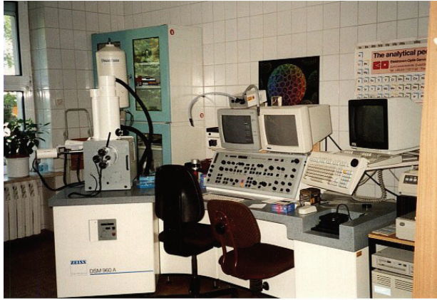
Abb. 18: Rasterelektronenmikroskop der Universität Rostock. Elektronenmikroskopisches Zentrum.
