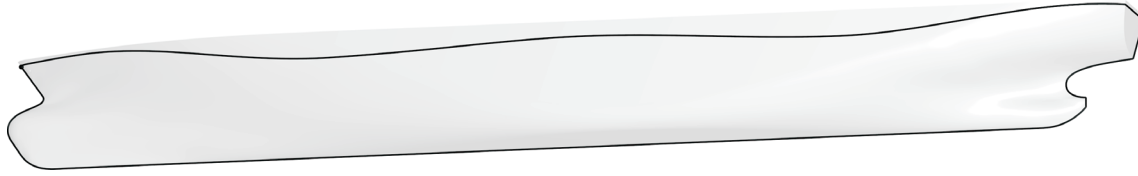
Abbildung 7.4: Ausgangsregionenmodell: Stevenkontur und Wasserlinie
