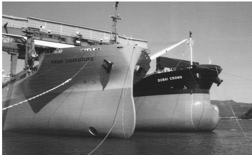
Abbildung 7.22: Neue Bugform eines bulk carriers (links), Bild entnommen aus [97]
