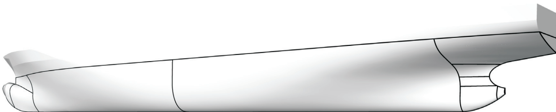
Abbildung 7.1: Beispiel der Aufteilung einer Schiffsform in Teilbereiche für die Panelnetzherstellung
