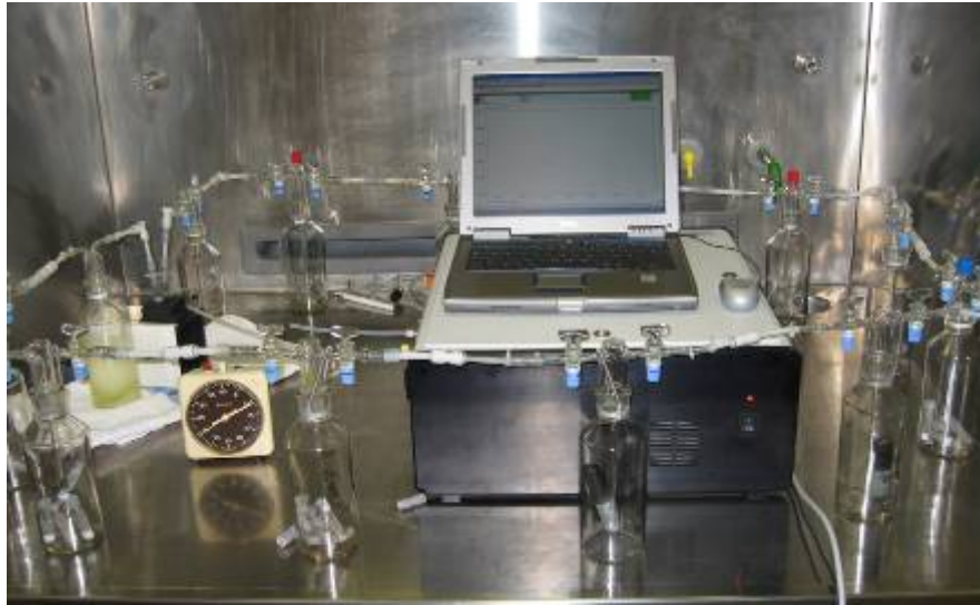
Abb. 67: Der Versuchsaufbau (FT-IR, Computer, Waschflaschen, Salzlösung, Uhr, Umwälzpumpe)
