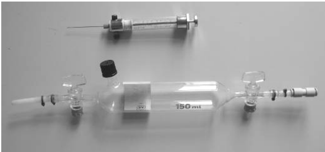
Abb. 64: 10-ml-Spritze (oben) mit Verschluss und 150-ml-Gasmaus (unten) mit Septum
