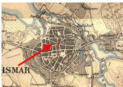
Abb. 5.5: Passpunkt in einem Kreuzungsmittelpunkt innerorts des Messtischblattes Nr. 664
