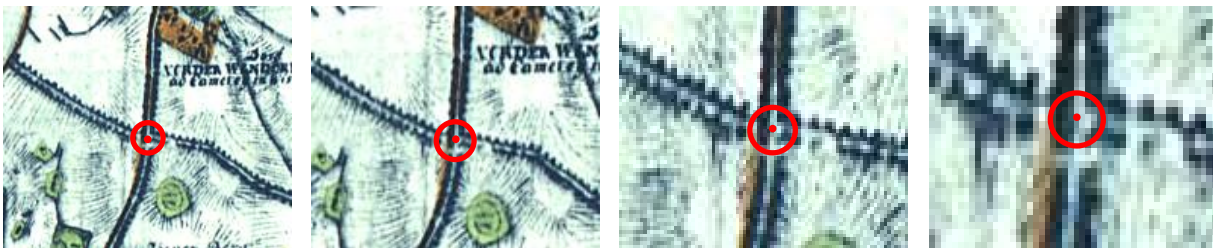
Abb. 5.8: Toleranzbereich einer sinnvoll möglichen Passpunktpositionierung innerhalb eines Kreuzungsbereichs bei steigender Vergrößerungsstufe der Karte Nr. 9 Wismar von Wiebeking
