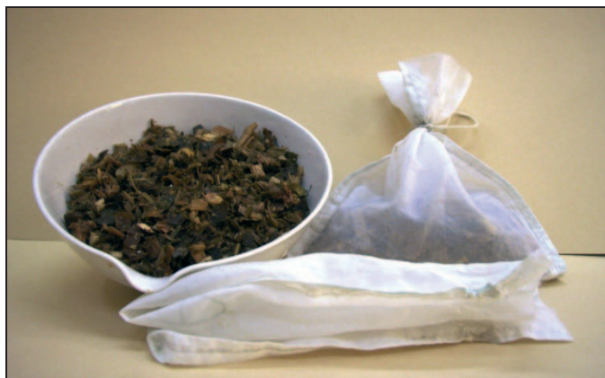
Abbildung 3.1: Material und Vergärungsbeutel der In-Sacco-Methode [BANEMANN 2007]
