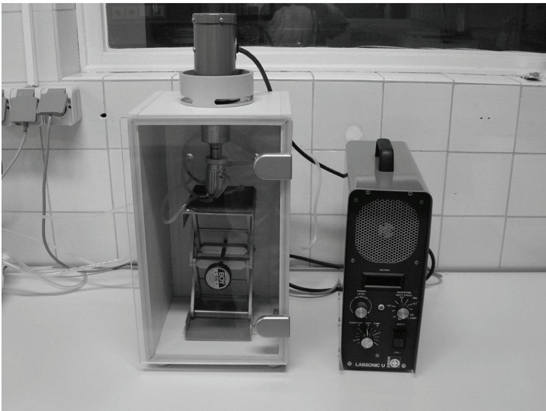
Abbildung 6: Ultraschallgenerator Labsonic U, B. Braun, Melsungen
