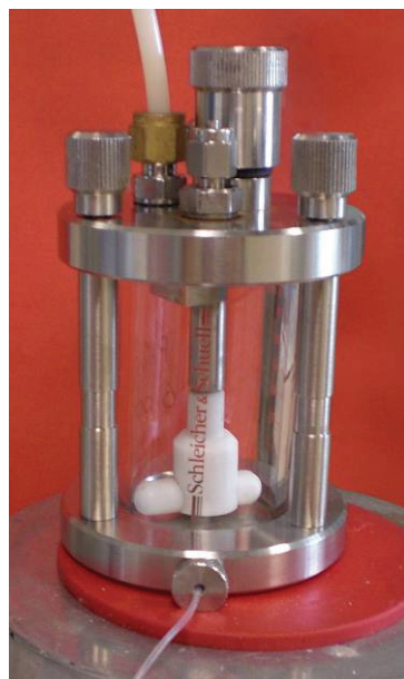
Abbildung 7-2: Rührzelle SC 75 von Schleicher & Schuell für Flachmembranen: Filtration der isolierten Cyanophycinproben (Charakterisierung der Rührzelle SC 75 von J. Kröckel 2005)
