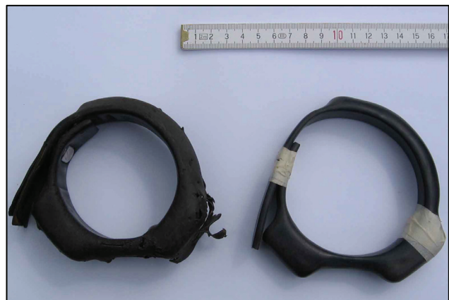
Abb. 8. Ausgefallener Sender Q- 5 / ER3(I) von Mhl (links); inaktiver Sender L – 2 / 1733 (I) (rechts) (Fa. Wagener, Köln )
