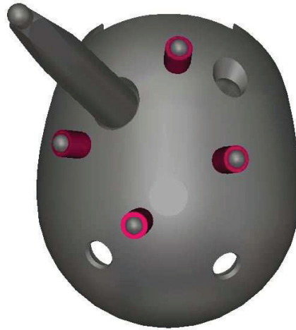
Abbildung 6.13: Implantat mit vier Stimulationselektroden auf der Oberfläche.
