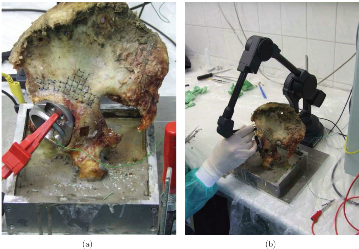
Abbildung A.2: (a) Fixierter humaner Beckenknochen mit eingesetztem geerdetem Implantat, vorbereitet zur Messung der Potentialverteilung im Knocheninneren. (b) Messung der Potentialverteilung an den Messpunkten mittels Messspitze und Messarm.
