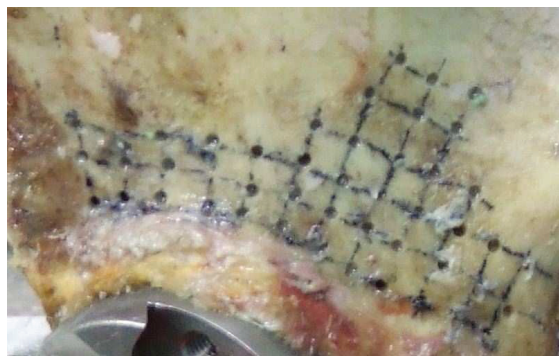
Abbildung A.3: Messfeld mit vorgebohrten Messlöchern zur Bestimmung des elektrischen Potentials.
