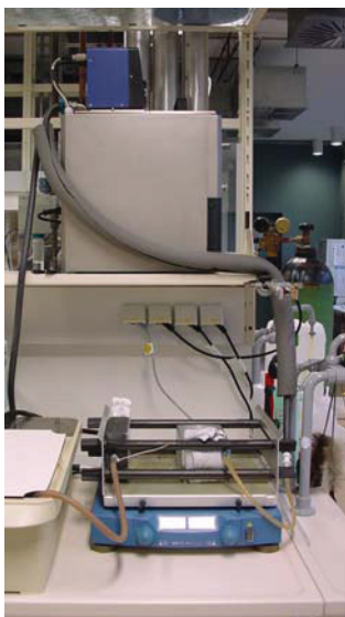
Abb. 9-3: Schüttler mit Thermostat (links) und Schüttler mit Heizblock aus Aluminium (rechts)
