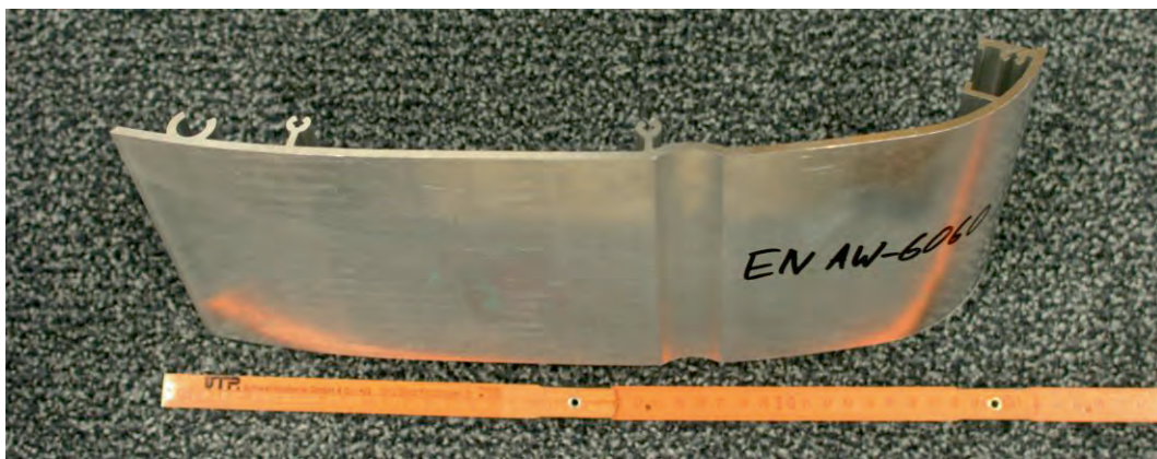
Abbildung 20: Profil aus dem die Proben der untersuchten Charge EN AW-6060 entnommen wurden.
