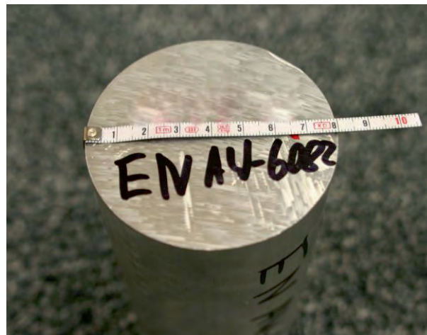
Abbildung 28: Profil aus dem die Proben der untersuchten Charge EN AW-6082 high entnommen wurden.
