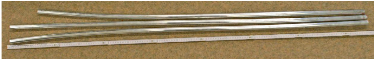
Abbildung 26: Rundprofile aus denen die Proben der untersuchten Charge EN AW-6082 low entnommen wurden.
