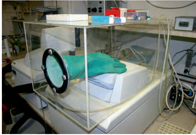
Abbildung 33: Handschuhbox auf einem Perkin-Elmer Pyris 1 DSC
