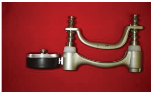
Abbildung 6: Jamar - Dynamometer mit verstellbarem Griff in 5 Positionen
