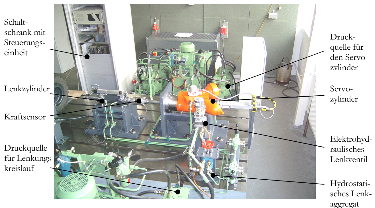
Bild 6.3 Aufbau des Lenkungsprüfstandes
