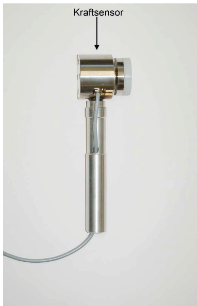
Abb. 7: Instrumentierter Hammer mit Kraftsensor der Fa. Hottinger Baldwin Messtechnik GmbH, Darmstadt, Deutschland.
