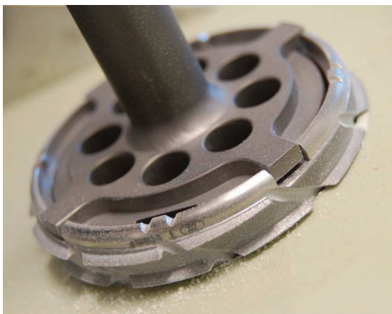
Abb. 20: Trident ® TC-Pfanne nach unvollständiger und verkippter Implantation in ep-Dur ® der Dichte 31 pcf durch Operateur 1.
