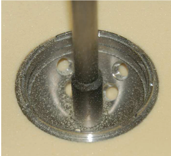
Abb. 28: Vollständig eingeschlagene Trident ® PSL-Pfanne in Sawbones ® der Dichte 10 pcf.
