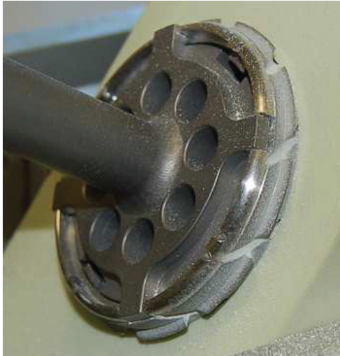
Abb. 21: Trident ® TC-Pfanne nach unvollständiger Implantation in ep-Dur ® der Dichte 31 pcf durch Operateur 2.
