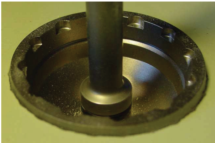
Abb. 27: Vollständiger Einbau der Ep-Fit Plus ® -Pfanne (Größe 56) in eine auf Pfannengröße 58 vorgefräste Kavität in PU-Schaum der Dichte 31 pcf.
