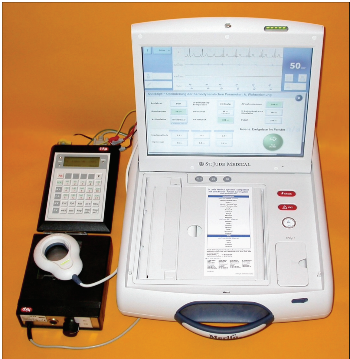
Abb. 15: In-vitro Versuchsaufbau: Eingeschalteter St. Jude Medical Programmer mit Basicunit ARSI-4 Rhythmus-Simulator von HKP (links oben), zugehöriger Defibrillatoradapter und Telemetriekopf (vorne).
