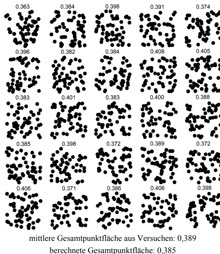
Abbildung 4.29: Gesamtpunktfläche für 25 Versuche mit jeweils 55 zufällig platzierten Punkten (Durchmesser 3 pt ) in einem Einheitsquadrat bei 10% Punktüberlappung [KIMERLING 2009, S. 173]
