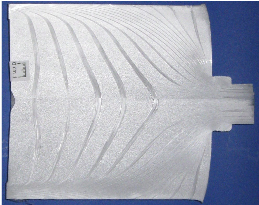
Abbildung 2.3: Materialfluss beim direkten Strangpressen eines Ø140 mm-Blockes aus EN AW-6082 mit 10 MN, sichtbar gemacht durch Indikator-Stifte aus EN AW-4043 (Ø4 mm) [6]
