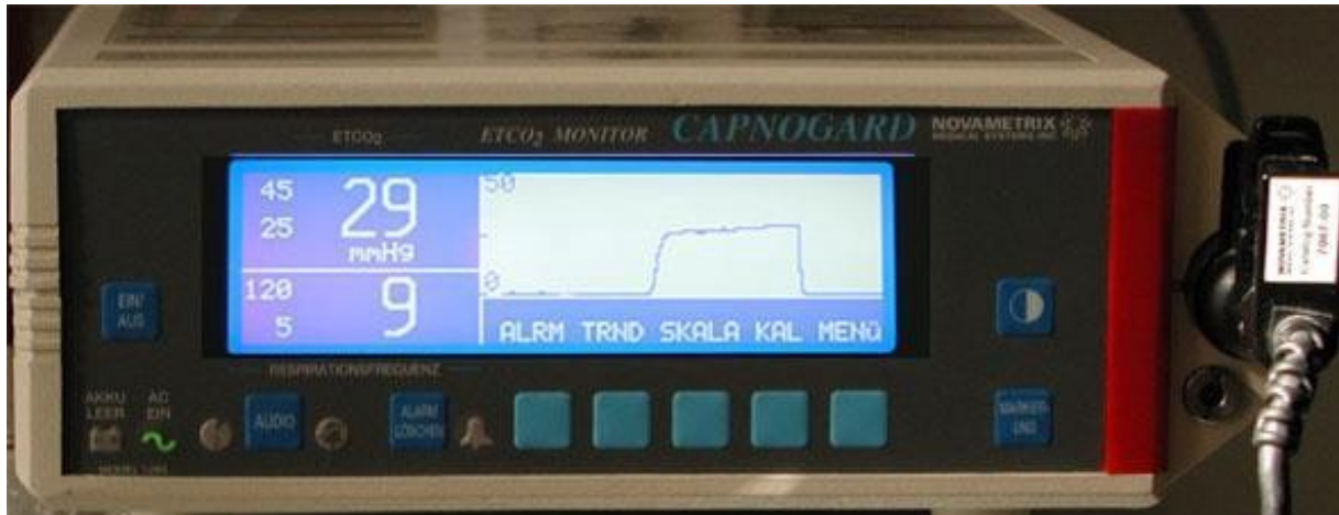
Abbildung 3: Für die Studie verwendetes Hauptstromkapnometer mit kapnographischer Darstellung eines Atemzyklus
