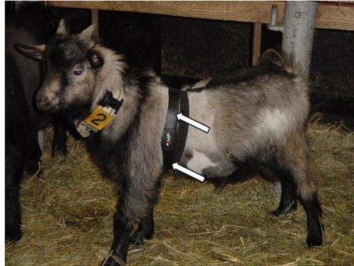
**Abbildung 5.4:** Zwergziege mit angelegtem Gurt zur Herzfrequenzmessung. Die Position der beiden Elektrodenflächen ist mit Pfeilen markiert. Der Empfänger zur Speicherung der Daten wurde durch eine Tasche am Halsband geschützt.
