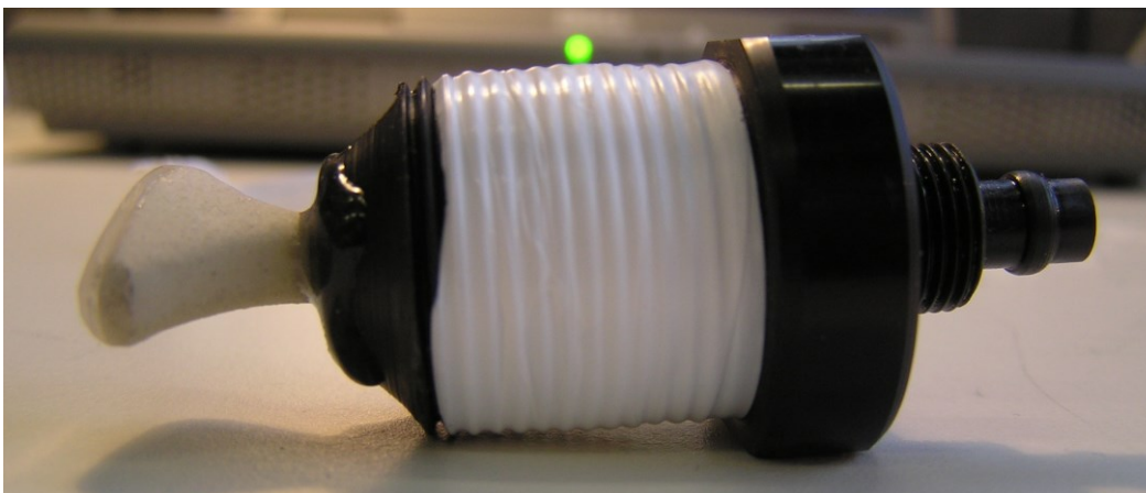
Abbildung 5-4 Adaptierter Keramikflügel mit 4 \text{ cm}^2 - Membranfläche
