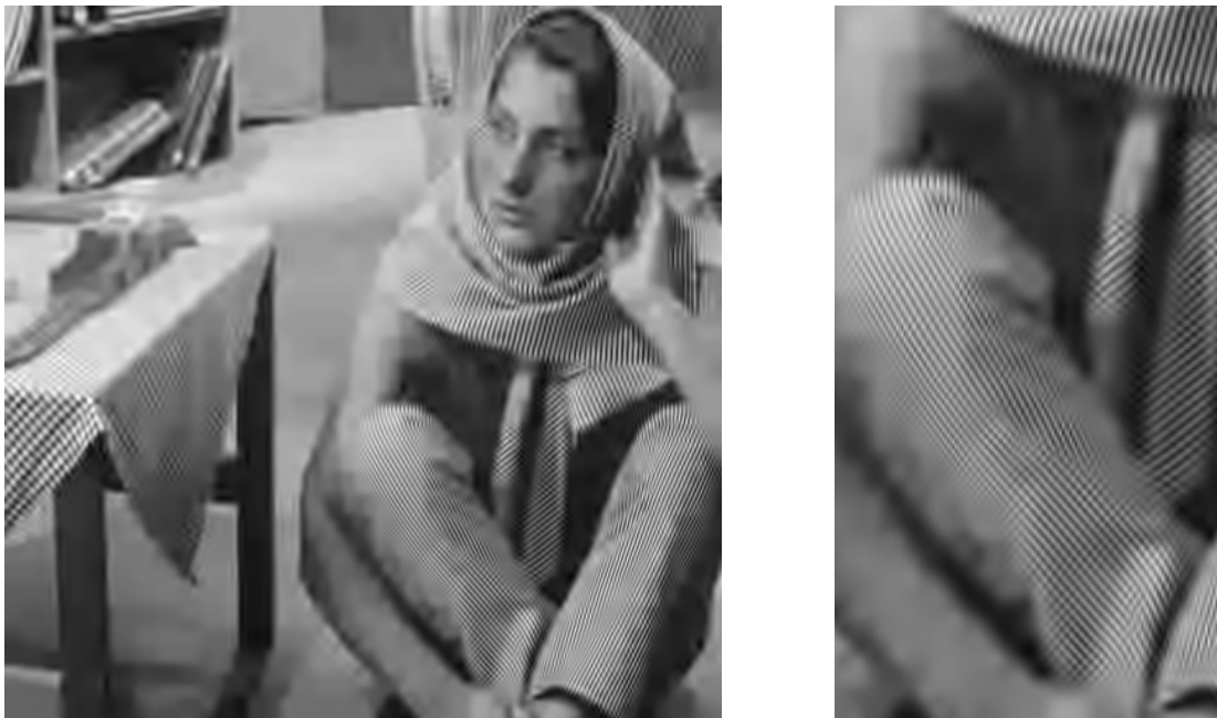
Abbildung H.192: AGU-Codec-I pp, 16 \times 32 LCT-2, PSNR = 26.44 dB.
