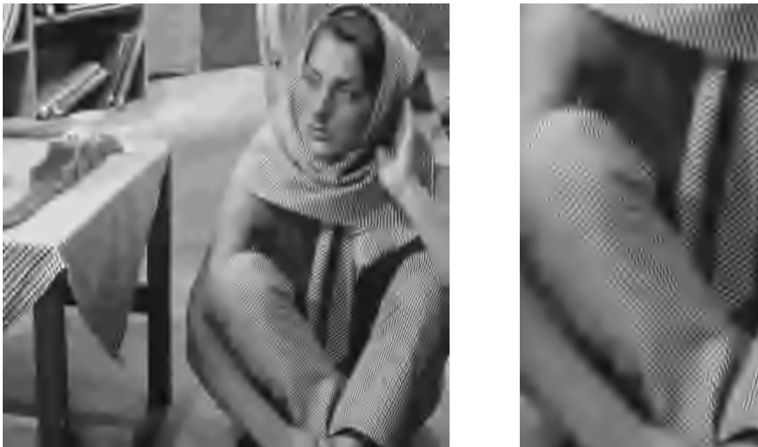
Abbildung H.292: L-CEB-Codec-I pp, 3-level DWT, PSNR = 24.42 dB.
