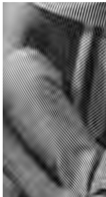
Abbildung H.226: SPIHT-Codec-I, 16 \times 64 LCT-4, PSNR = 25.85 dB.
