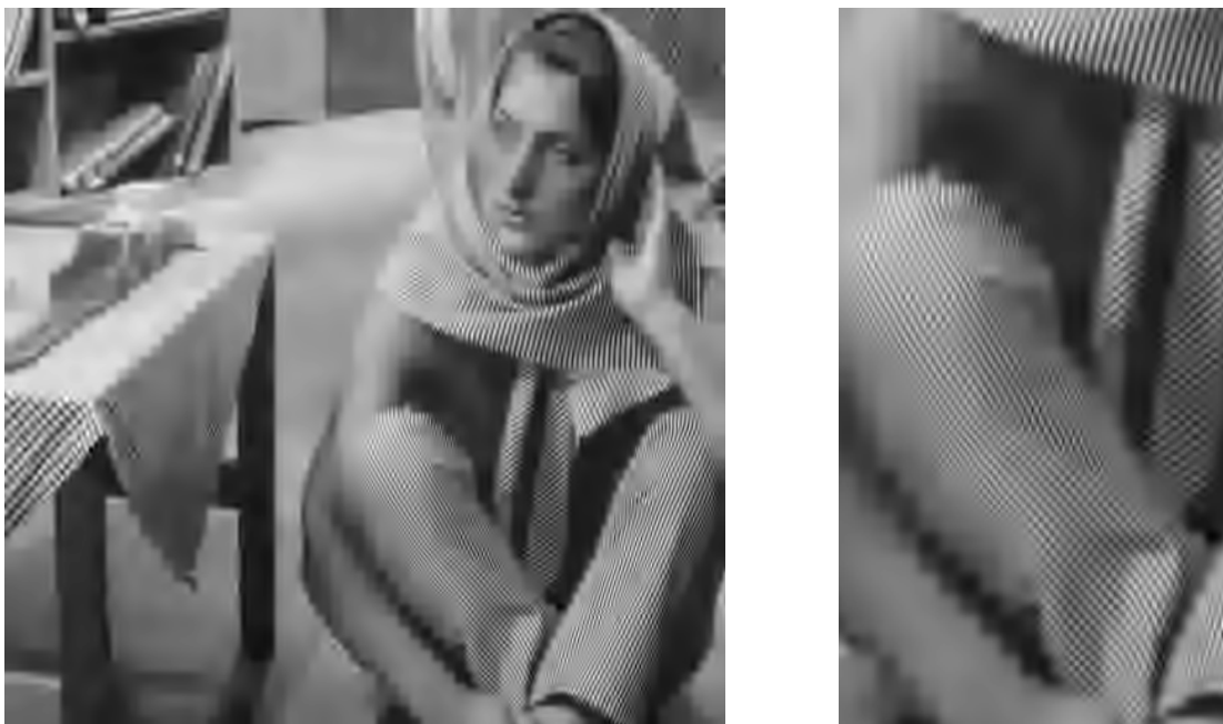
Abbildung H.273: SPIHT-Codec-II pp, 8 \times 32 GenLOT & 3-level DWT, PSNR = 25.46 dB.
