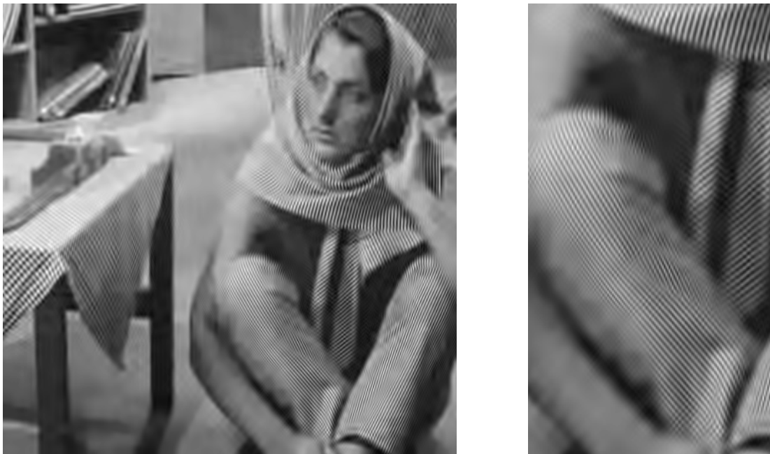
Abbildung H.200: AGU-Codec-I pp, 32 \times 64 LCT-2, PSNR = 26.98 dB.
