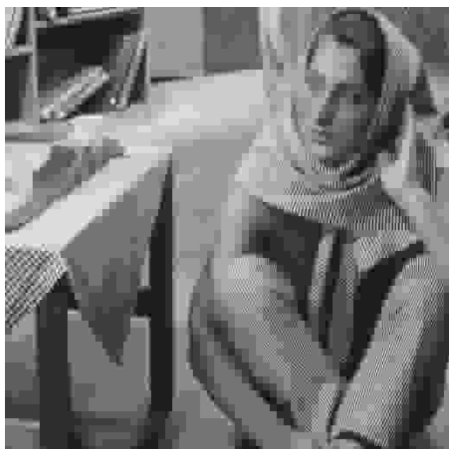
Abbildung H.158: SPIHT-Codec-I, 8 \times 8 DCT, PSNR = 23.23 dB.
