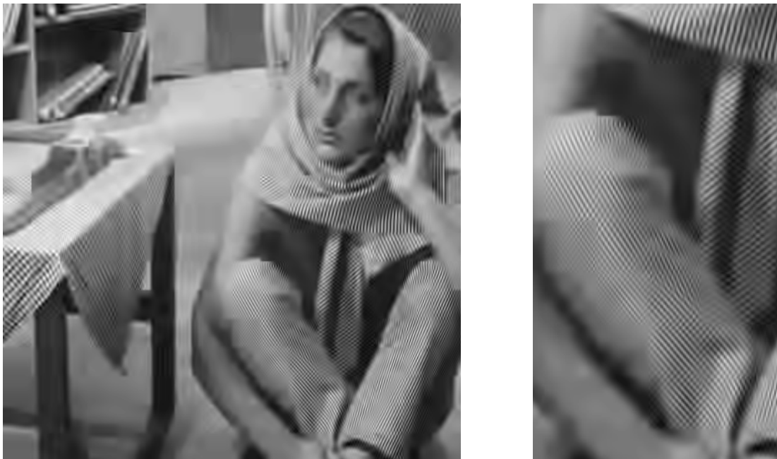
Abbildung H.172: SPIHT-Codec-I pp, 32 \times 32 DCT, PSNR = 25.75 dB.
