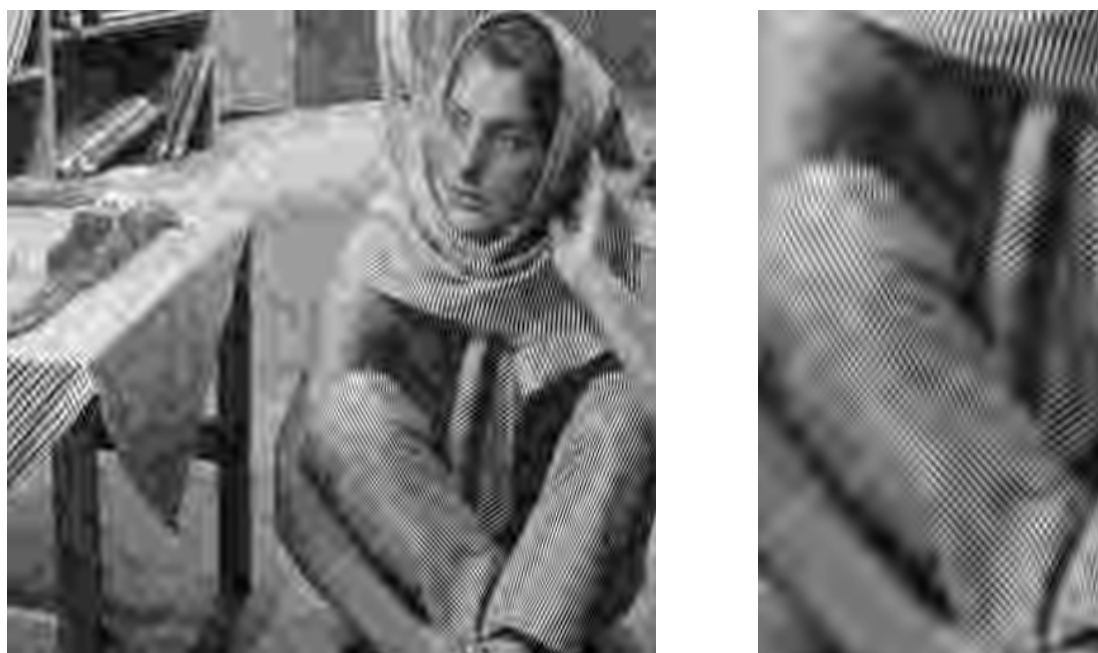
Abbildung H.238: SPIHT-Codec-I, 8 \times 48 LCT-6, PSNR = 24.03 dB.
