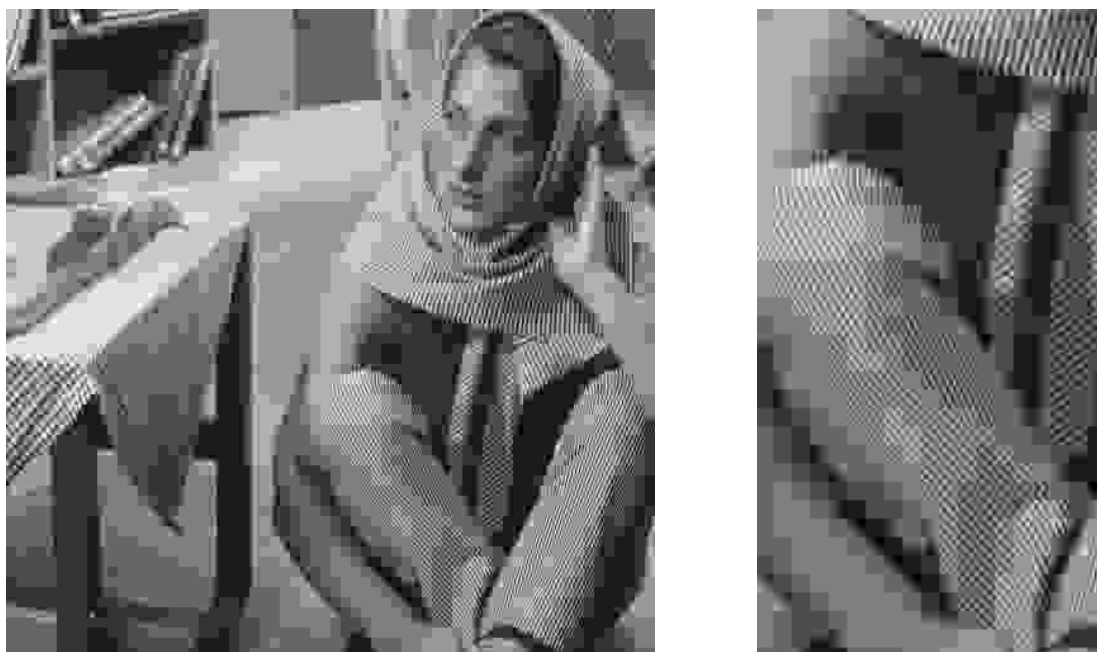
Abbildung H.153: JPEG Coder [IJG11] mit arithmetischer Codierung und skalarer Quantisierung (keine wahrnehmungsangepasste Quantisierung) , 8 \times 8 DCT, Bitrate = 0.11 bpp, PSNR = 23.19 dB.
