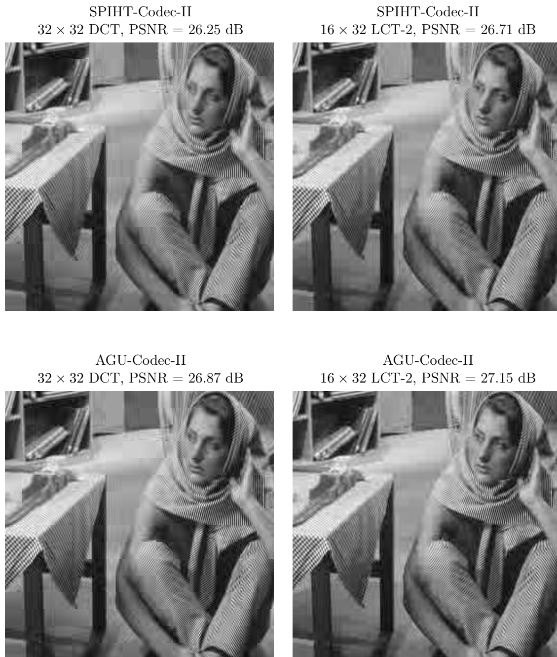
Abbildung 5.14: AGU-Codec-II und SPIHT-Codec-II im Vergleich: Kompression des Bildes „Barbara“ bei einer Bitrate von 0.125 bpp unter Verwendung der 32 \times 32 DCT (links) und der 16 \times 32 LCT-2 (rechts).
