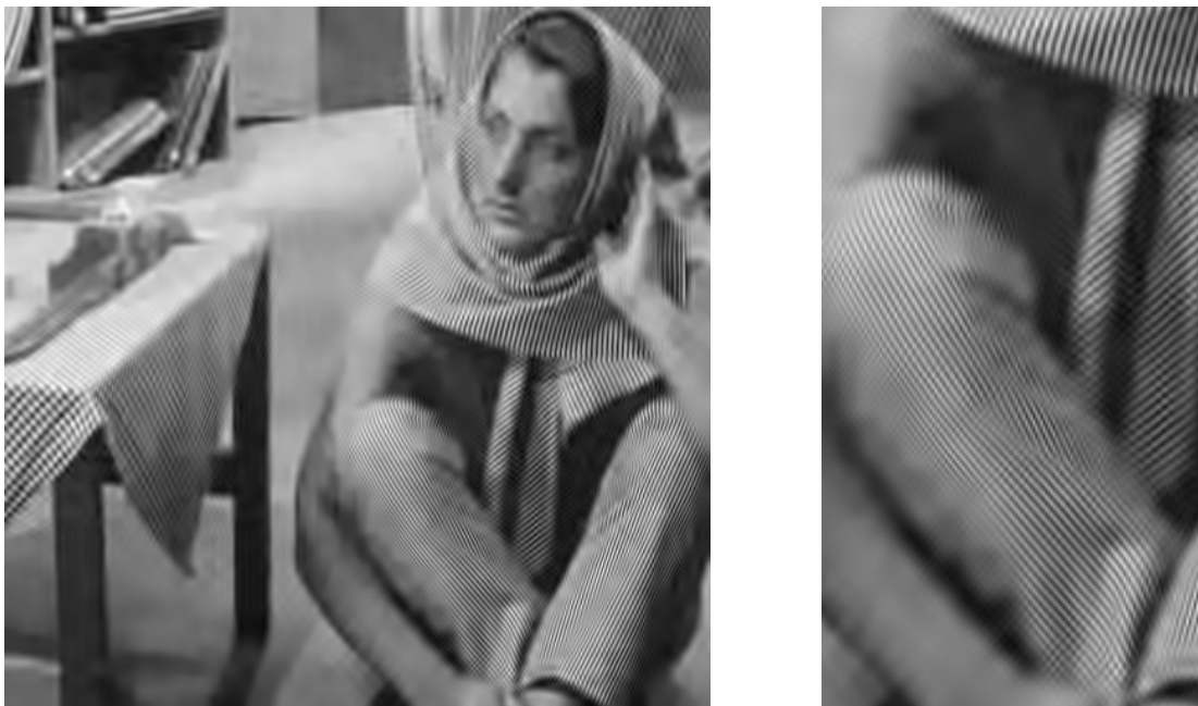
Abbildung H.201: AGU-Codec-II pp, 32 \times 64 LCT-2 & 1-level DWT, PSNR = 26.96 dB.
