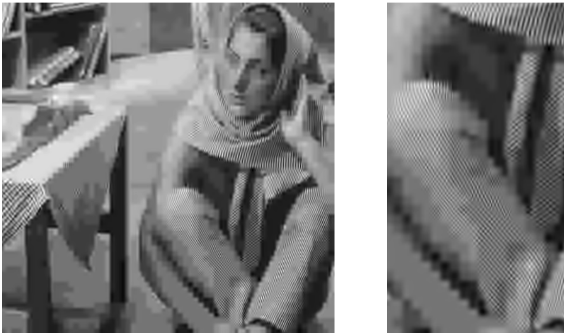
Abbildung H.184: SPIHT-Codec-I pp, 8 \times 16 LCT-2, PSNR = 24.62 dB.
