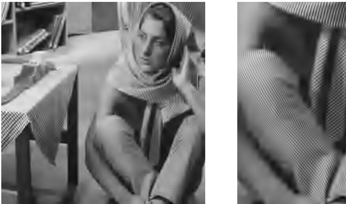
Abbildung H.285: L-CEB-Codec-II pp, 8 \times 32 ELT & 3-level DWT, PSNR = 26.32 dB.
