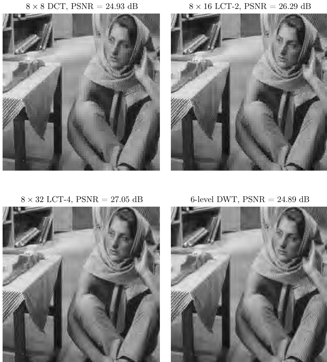
Abbildung 5.11: L-CEB-Codec-II: Kompression des Bildes „Barbara“ bei einer Bitrate von 0.125 bpp; Vergleich von 8 \times 8 DCT, 8 \times 16 LCT-2, 8 \times 32 LCT-4 und 6-level DWT (9/7-Wavelet). Bei den trigonometrischen Transformationen wird das 64 \times 64 DC-Teilband mit der 3-level DWT (9/7-Wavelet) weiterverarbeitet, so dass hieraus resultierend bei allen Kompressionsbeispielen das DC-Teilband aus 8 \times 8 Transformationskoeffizienten besteht.
