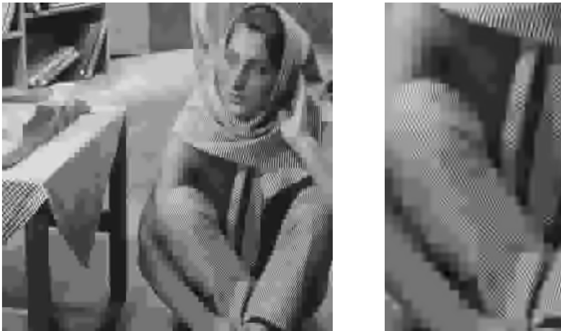
Abbildung H.160: SPIHT-Codec-I pp, 8 \times 8 DCT, PSNR = 23.92 dB.
