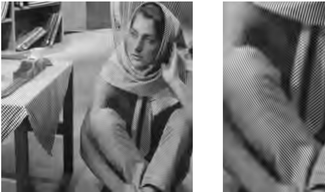
Abbildung H.216: AGU-Codec-I pp, 16 \times 48 LCT-3, PSNR = 26.27 dB.
