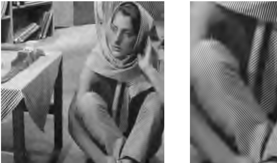
Abbildung H.236: L-CEB-Codec-I pp, 8 \times 48 LCT-6, PSNR = 26.20 dB.
