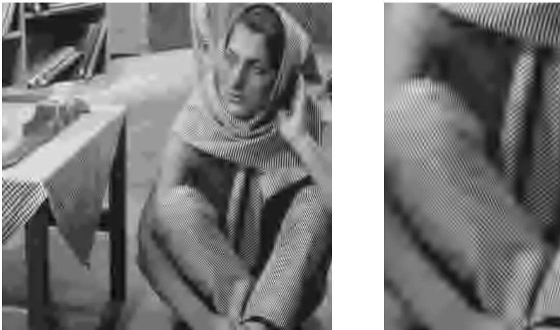
Abbildung H.280: SPIHT-Codec-I pp, 8 \times 48 GenLOT, PSNR = 25.02 dB.
