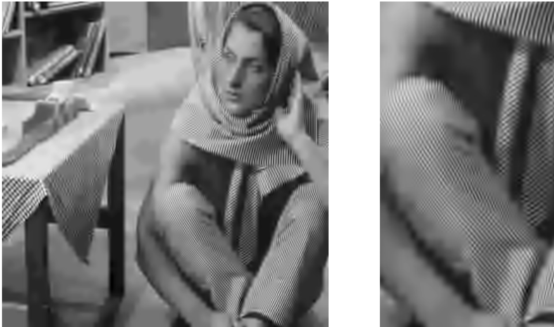
Abbildung H.252: L-CEB-Codec-I pp, 8 \times 16 TDLT, PSNR = 25.83 dB.
