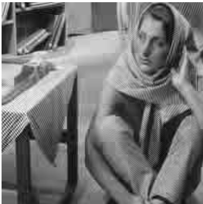
Abbildung H.170: SPIHT-Codec-I, 32 \times 32 DCT, PSNR = 25.53 dB.
