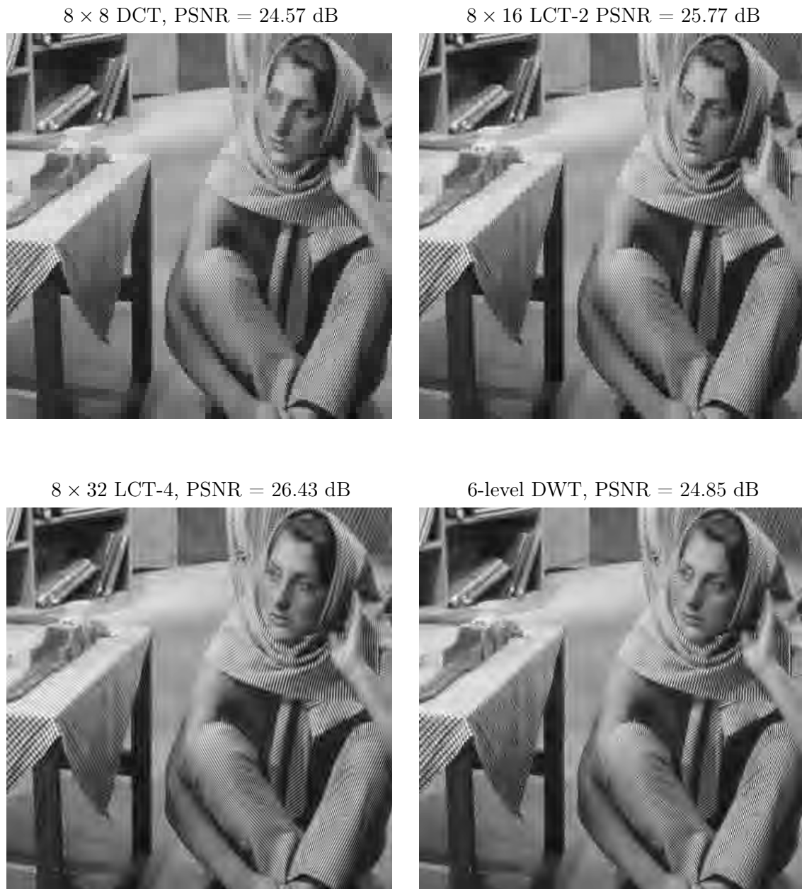
Abbildung 5.8: SPIHT-Codec-II: Kompression des Bildes „Barbara“ bei einer Bitrate von 0.125 bpp; Vergleich von 8 \times 8 DCT, 8 \times 16 LCT-2, 8 \times 32 LCT-4 und 6-level DWT (9/7-Wavelet). Bei den trigonometrischen Transformationen wird das 64 \times 64 DC-Teilband mit der 3-level DWT (9/7-Wavelet) weiterverarbeitet, so dass hieraus resultierend bei allen Kompressionsbeispielen das DC-Teilband aus 8 \times 8 Transformationskoeffizienten besteht.
