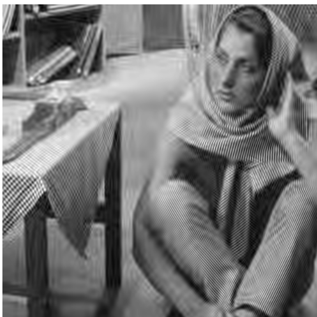
Abbildung H.231: AGU-Codec-II, 16 \times 64 LCT-4 & 2-level DWT, PSNR = 26.37 dB.
