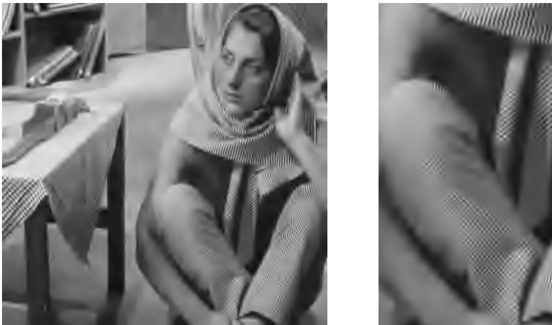
Abbildung H.301: SPIHT pp, 6-level DWT, PSNR = 24.38 dB.
