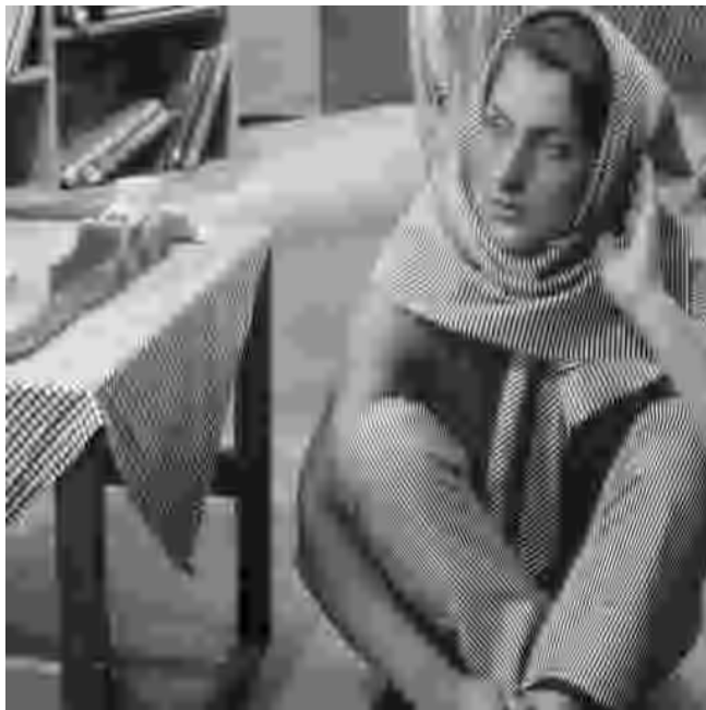
Abbildung H.250: L-CEB-Codec-I, 8 \times 16 TDLT, PSNR = 25.57 dB.
