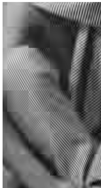
Abbildung H.170: SPIHT-Codec-I, 32 \times 32 DCT, PSNR = 25.53 dB.
