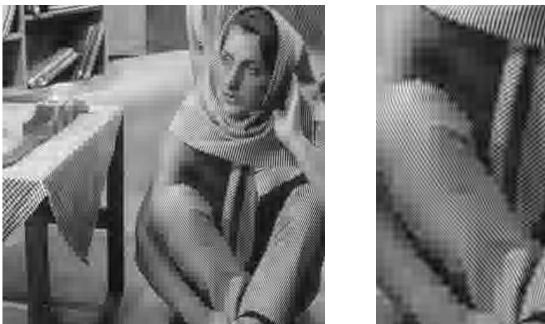
Abbildung H.259: L-CEB-Codec-II, 8 \times 16 LOT-II & 3-level DWT, PSNR = 25.37 dB.
