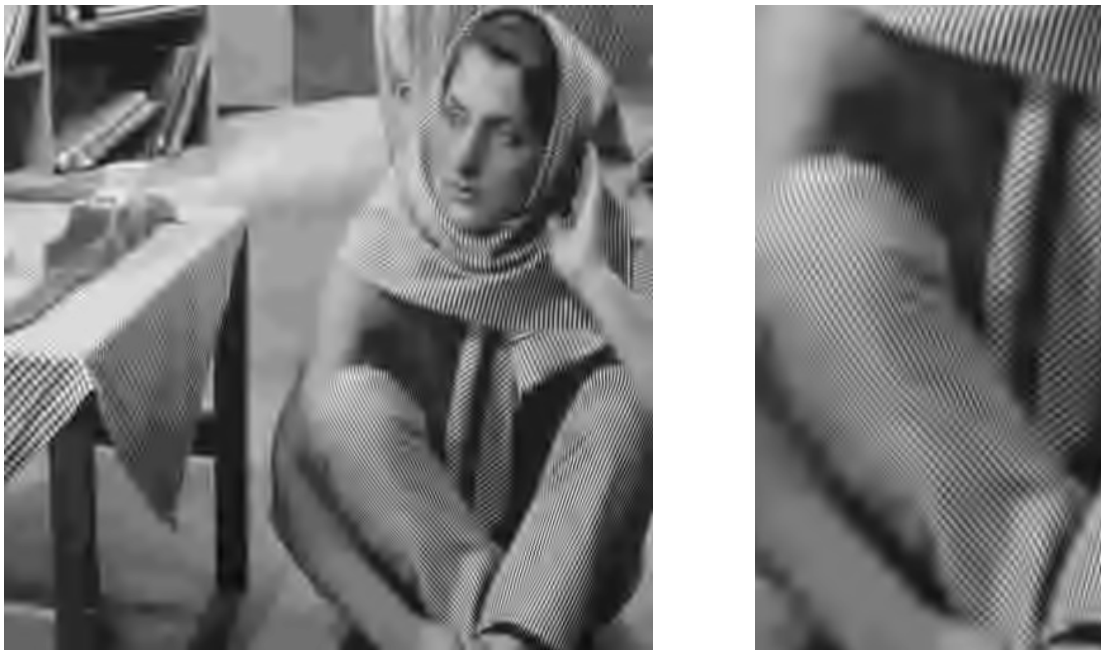
Abbildung H.276: L-CEB-Codec-I pp, 8 \times 48 GenLOT, PSNR = 26.20 dB.
