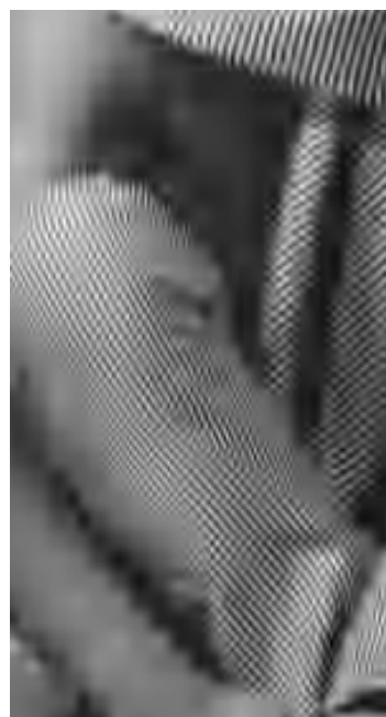
Abbildung H.255: SPIHT-Codec-II, 8 \times 16 TDLT & 3-level DWT, PSNR = 25.33 dB.
