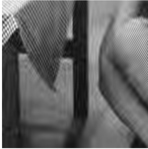
Abbildung 1.3: Sichtbare Ringing-Artefakte, die in der Umgebung von Kanten durch die Rekonstruktion mit schlecht lokalisierten Basisfunktionen nach starker Quantisierung der Wichtungskoeffizienten auftreten.
