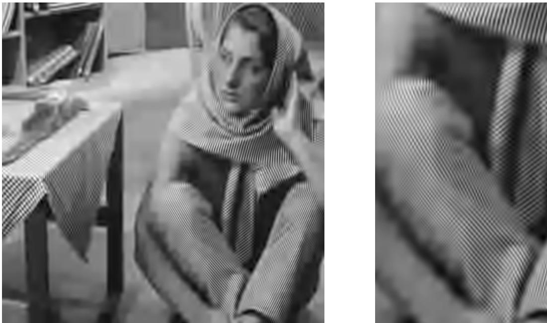
Abbildung H.188: SPIHT-Codec-I pp, 16 \times 32 LCT-2, PSNR = 26.00 dB.
