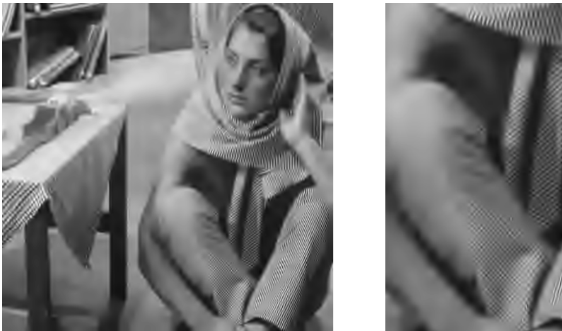
Abbildung H.297: AGU-Codec-II pp, 6-level DWT, PSNR = 24.66 dB.
