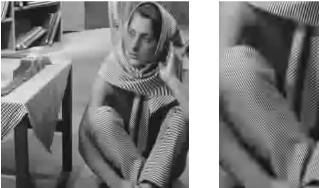
Abbildung H.168: AGU-Codec-I pp, 16 \times 16 DCT, PSNR = 25.61 dB.
