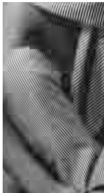
Abbildung H.174: AGU-Codec-I, 32 \times 32 DCT, PSNR = 26.06 dB.
