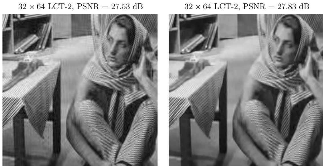
Abbildung 5.15: AGU-Codec-II: Kompression des Bildes „Barbara“ bei einer Bitrate von 0.125 bpp; Vergleich von 32 \times 64 LCT-2 (links) und 32 \times 64 LCT-2 mit DCT-basierter Postfilterung (rechts).
