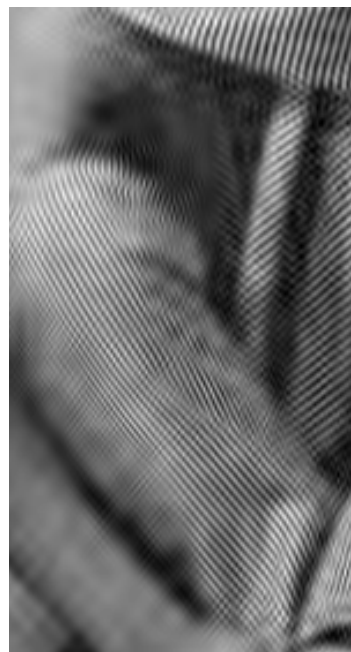
Abbildung H.198: AGU-Codec-I, 32 \times 64 LCT-2, PSNR = 26.72 dB.
