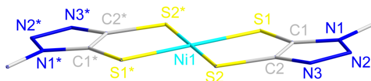
Abb. 34: Seitliche Ansicht der Molekülstruktur von 29 2- im Einkristall als wire-and-stick model . Die Wasserstoffatome und fehlgeordneten Tetraethylammonium-Gegenionen sind aus Gründen der Übersichtlichkeit nicht abgebildet. Weiterhin werden die 2,6-Dimethylphenyl-Substituenten am Triazol-Rückgrat nur mit dem gebundenen Kohlenstoffatom angedeutet.
