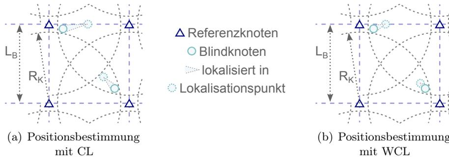
Abbildung 3.2: Positionsbestimmung mittels CL und WCL im Vergleich: (a) CL, (b) WCL.
