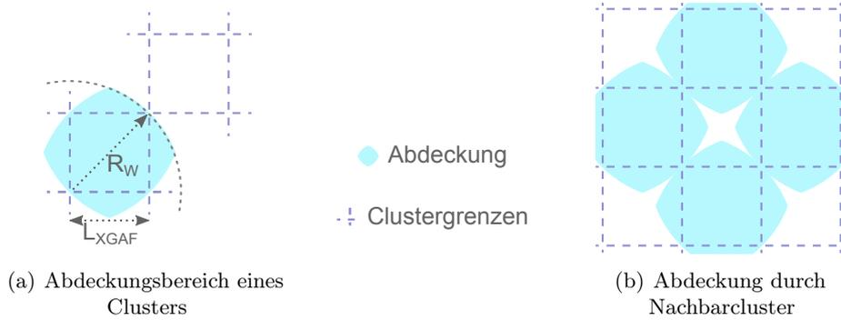
Abbildung 4.5: Abdeckungsbereiche bei Verwendung von XGAF-Clustern: (a) Abdeckung durch einen Cluster, (b) Abdeckung eines Clusters durch vier angrenzende Nachbarn.
