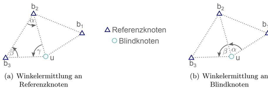
Abbildung 2.25: Beispielhafte Darstellung der Triangulation in einem drahtlosen Sensornetzwerk: (a) Ermittlung der Winkel durch Referenzknoten, (b) Ermittlung der Winkel durch den Blindknoten.
