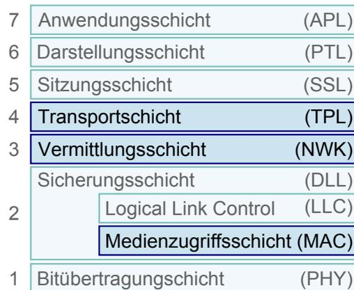
Abbildung 2.4: Das erweiterte OSI-Referenzmodell für Kommunikationsprotokolle in Rechnernetzen.
